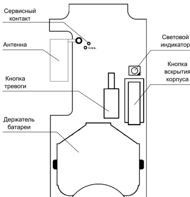
Рисунок 2.2.2.4-1 Расположение элементов на плате
