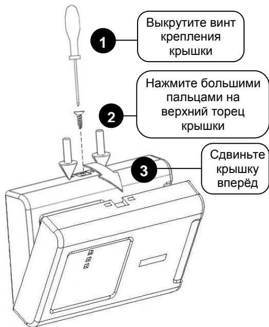
Рисунок 2. Снятие крышки блока
