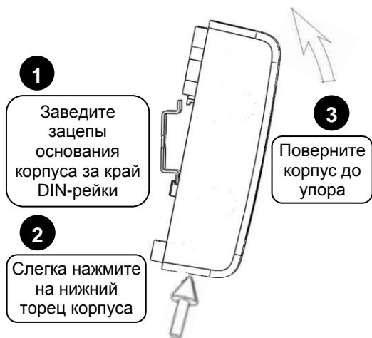
Рисунок 3. Крепление блока на DIN-рейку
