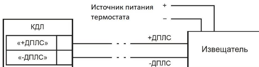
Рис. 4 – Типовая схема включения извещателя в двухпроводную линию связи КДЛ
