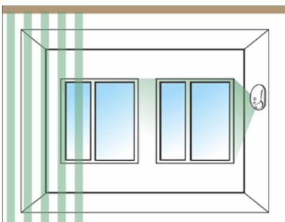
Рисунок 2.2.3.2.5 Установка извещателя между стеклом и занавесками (жалюзи)
