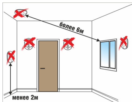
Рисунок 2.2.3.2.6 НЕрекомендуемые места установки извещателя
