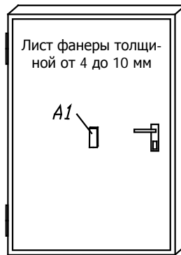
Рисунок 7. Защита деревянной пустотелой двери
