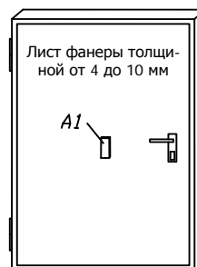
Рисунок 6. Защита деревянной пустотелой двери
