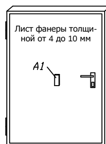
Рисунок 6. Защита деревянной пустотелой двери
