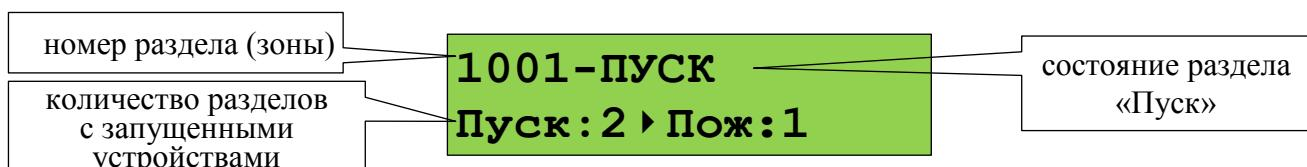
При запуске с задержкой отображается раздел (зона) с устройствами, которые будут запущены первыми, при этом на ЖКИ отображается время до запуска в секундах.
