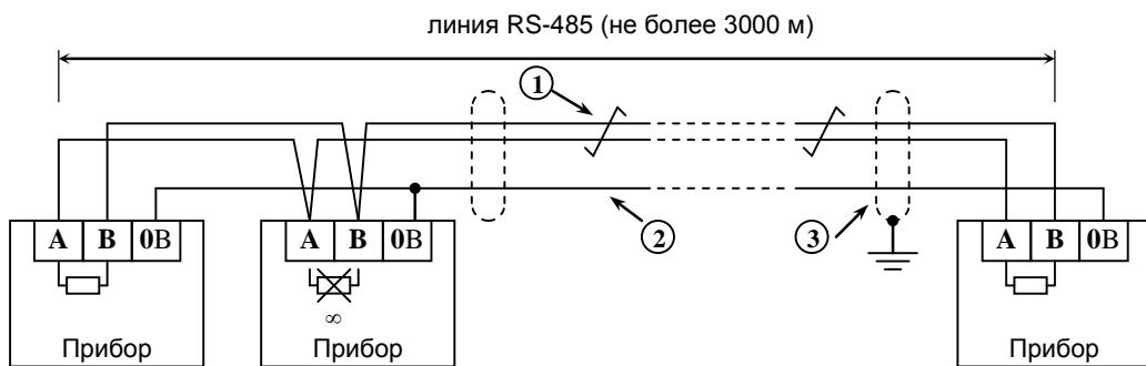
**Прибор** – прибор ИСО «Орион», имеющий возможность подключения к пульту «С2000М» посредством интерфейса RS-485 (до 127 шт.) или пульту «С2000М» (не более 1 шт.);
