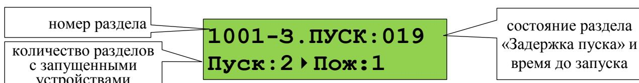
Ручной пуск устройств в зоне (например, пуск оповещения без задержки) можно выполнить нажатием кнопки ПУСК, отменить запуск устройств или вернуть их в исходное состояние после запуска (выключить) можно с помощью кнопки СТОП (см. п.3.10) . Эти, а также другие доступные команды, можно выдать с помощью контекстного меню, которое вызывается кнопкой ≡.
