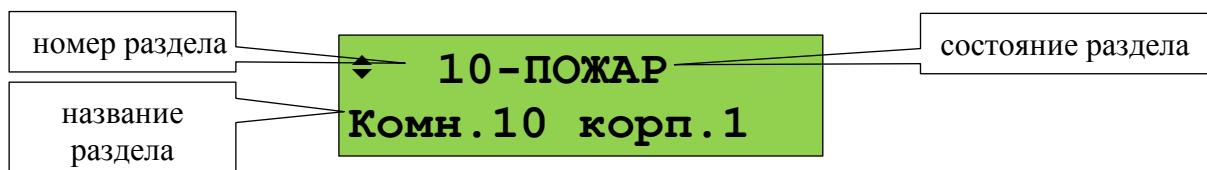
Названия состояний приведены в Приложении Г. При наличии разделе (зоне) элементов с различными состояниями отображается наиболее приоритетное состояние. Имеется несколько особых состояний раздела (зоны):
