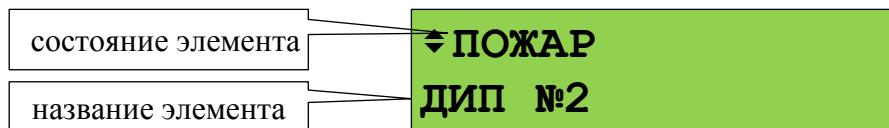
Кнопками ▶, ← можно просмотреть другие элементы раздела в пожаре (кнопкой ▶ в порядке получения событий, кнопкой ← - в обратном порядке). Для просмотра времени и даты пожара нужно нажать и удерживать кнопку 0. При нажатии кнопки 1 отобразится информация об адресе модуля и номере извещателя или ШС. Сброс сработавшего элемента можно выполнить кнопкой СБРОС или через контекстное меню, которое вызывается кнопкой ≡.
