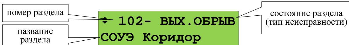
Другие разделы, содержащие неисправности, можно просмотреть кнопками **◀**, **►**. Кнопкой **◀** осуществляется переход к просмотру неисправных элементов раздела (отдельных ШС, адресных извещателей, выходов и т.п.):
