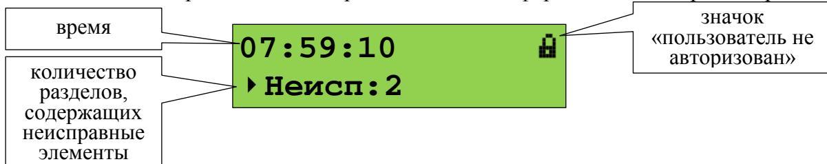
Чтобы просмотреть неисправные разделы, нужно нажать кнопку **►** (кнопки **◀**, **►** осуществляют переключение между просмотром «Пусков», «Пожаров», «Тревог», «Остановов», «Неисправностей» и «Отключений»). Отобразится информация о первом разделе, в котором присутствует неисправность:
