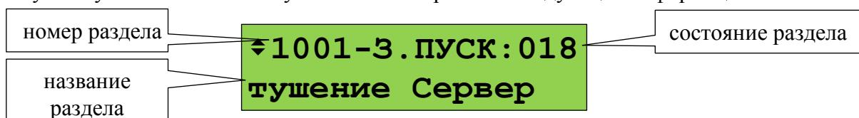
Просмотр всех зон (разделов) с запущенными устройствами осуществляется кнопками ▶, ◀. Кнопка ▶ пролистывает разделы в порядке запуска устройств, кнопка ◀ - в обратном порядке. Для определения запущенных элементов (устройств) в разделе нужно нажать кнопку ← . Отобразится информация о первом запущенном устройстве. При запуске с задержкой отобразится устройство, которое будет запущено первым:
