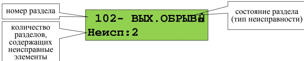
Затем нужно нажать **◀**. Отобразится информация о первом разделе с неисправностью:
