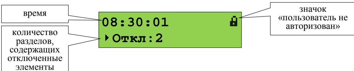
Для отображения первого раздела, содержащего отключенный элемент, нужно выбрать отображение отключенных разделов кнопкой **▶** и нажать **◀**. Отобразится информация о первом разделе, содержащем отключенные элементы. Просмотр других разделов с отключеными элементами выполняется кнопками **◀**, **▶**. Для просмотра отключенных элементов раздела нужно нажать **◀**, после чего просмотр отключенных элементов выполняется кнопками **◀**, **▶**.
