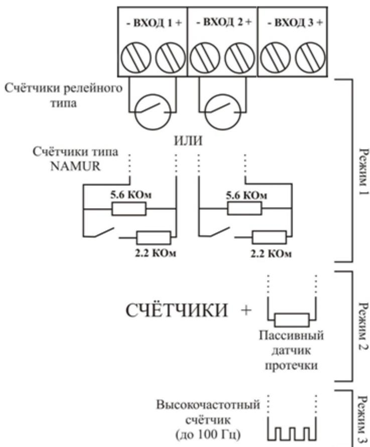
Рисунок 2.4 Варианты подключения счётных устройств и датчиков
