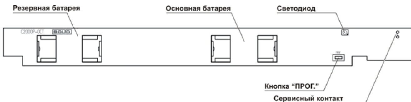
Рисунок 2.3 Расположение элементов на плате аппаратной версии 2.0
