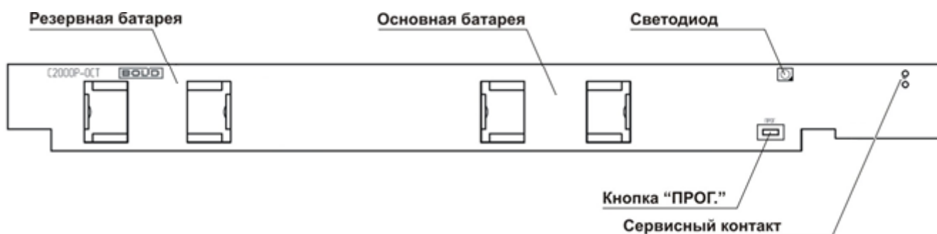
Рисунок 2.3 Расположение элементов на плате аппаратной версии 2.0
