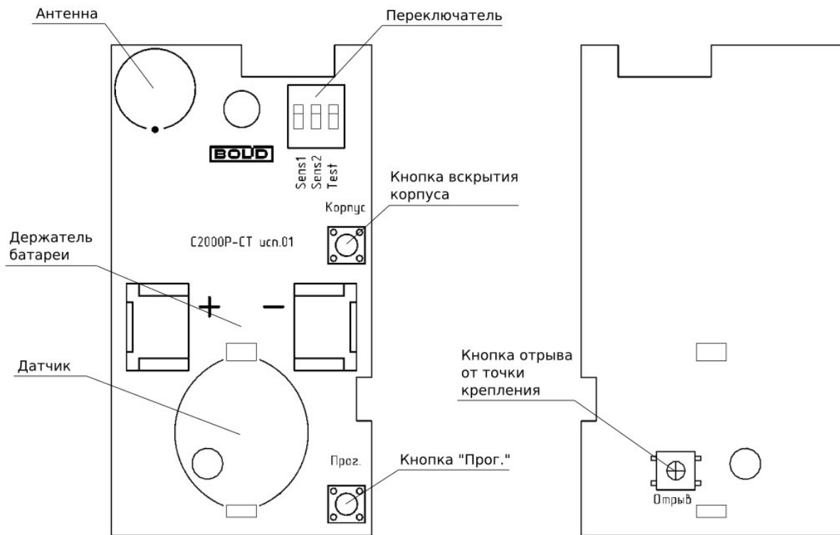
Рисунок 2.2 Расположение элементов на плате
