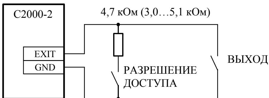
Рисунок 6 Схема подключения кнопки "ВЫХОД" и кнопки "РАЗРЕШЕНИЕ ДОСТУПА"
