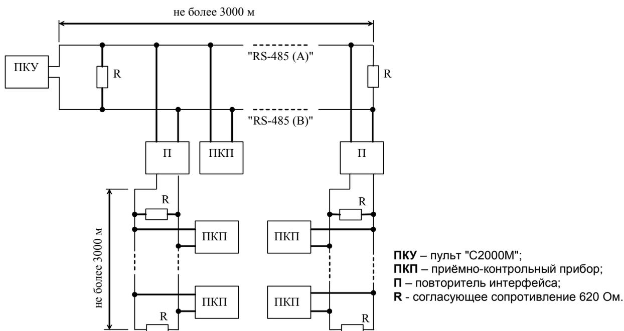
**Рисунок 4** Построение конфигурации "звезда" при помощи повторителей интерфейса
