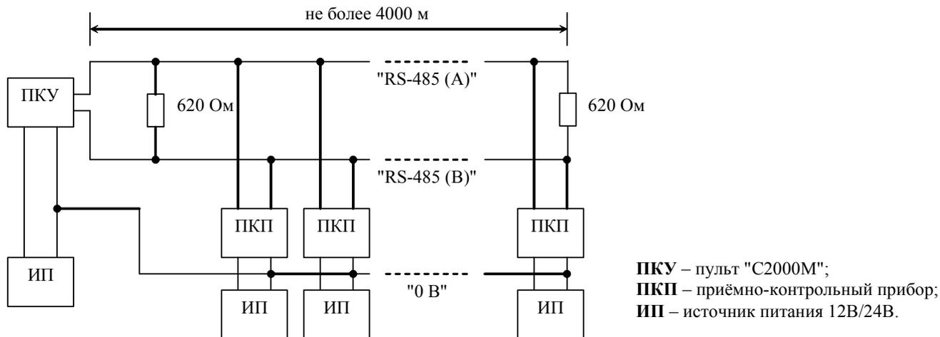
**Рисунок 2** Схема подключения приборов к магистральному интерфейсу RS-485
