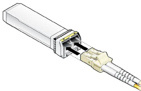
Рисунок 5.4 – Подключения кабеля
