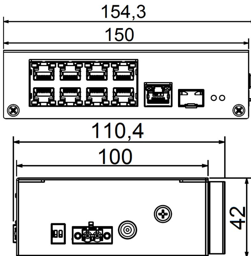
Рисунок 5.1 – Габаритные размеры
