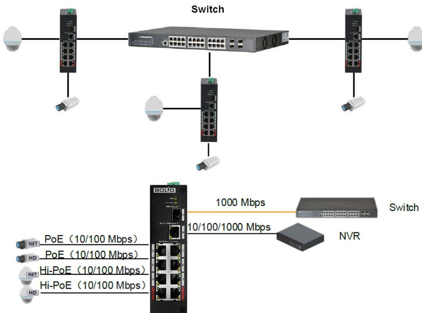
Рисунок 1.1 – Сетевое соединение
