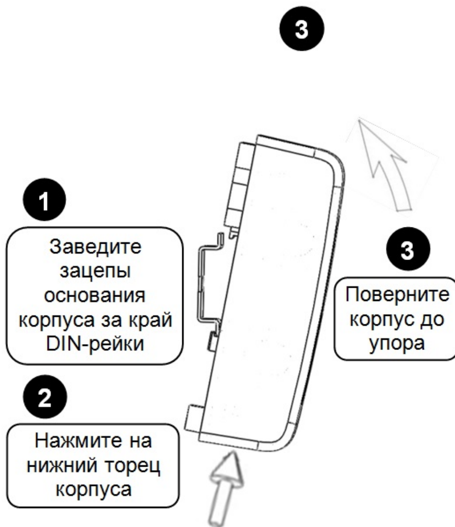
Рисунок 4. Крепление «УО-4С исп.02» на DIN-рейку
