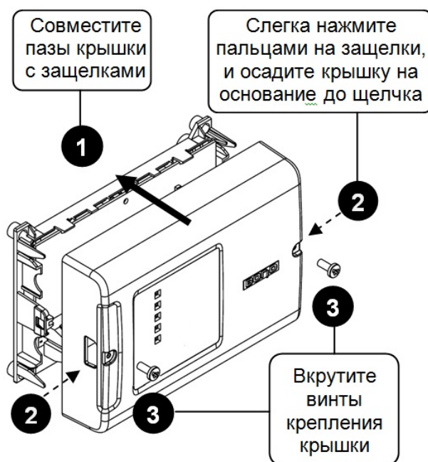
Рисунок 8. Монтаж крышки
