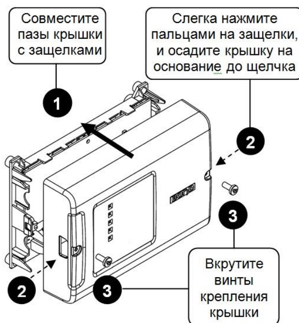
Рисунок 8. Монтаж крышки
