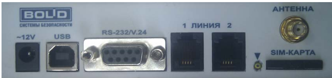
Рисунок 1. Задняя крышка «УОП-3 GSM» с разъёмами
