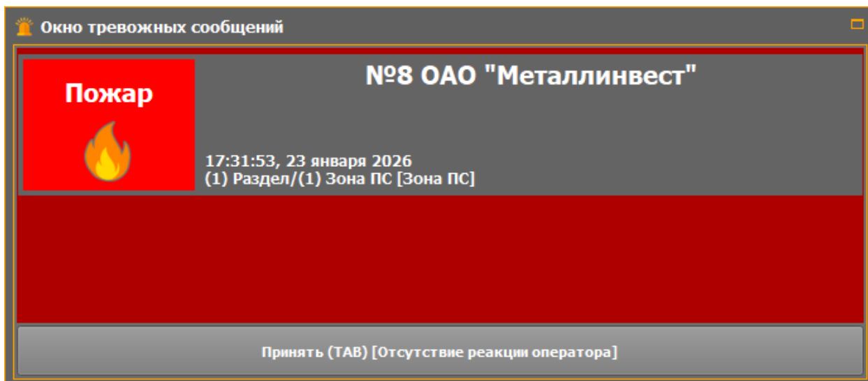
Рисунок 80 Отсутствие реакции оператора на окно тревожных сообщений
