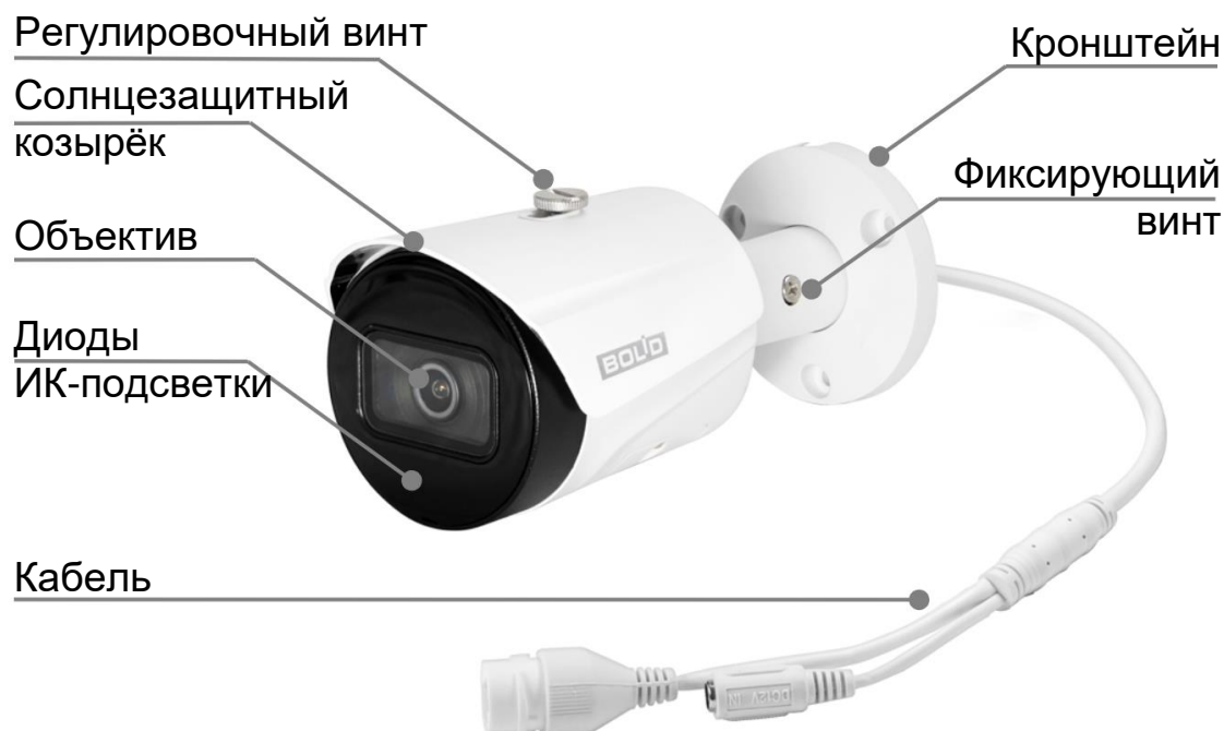
Рисунок 4.1 – Внешний вид и основные элементы видеокамеры
