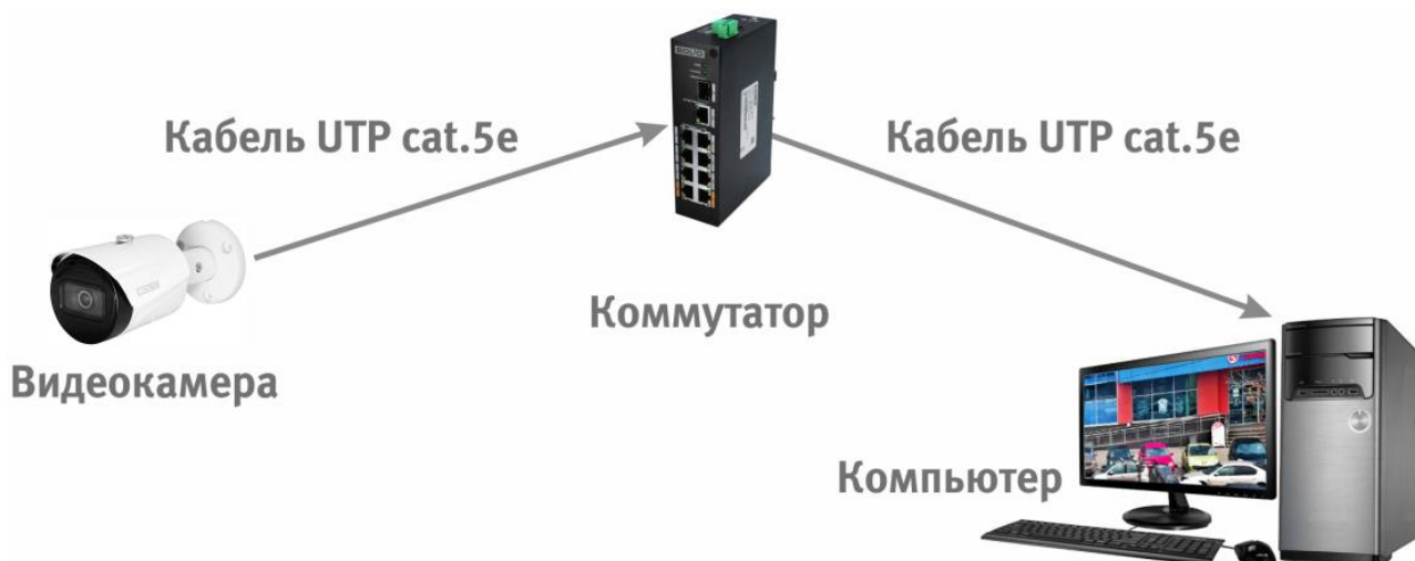
Рисунок 6.3 – Схема подключения видеокамеры к компьютеру через коммутатор
