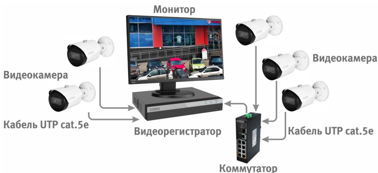
Рисунок 6.4 – Схема подключения видеокamеры к видеорегистратору
