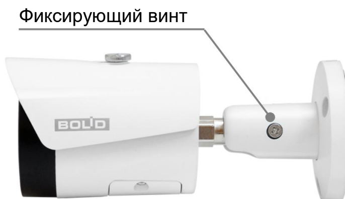
Рисунок 5.14 – Настройка направления объектива
