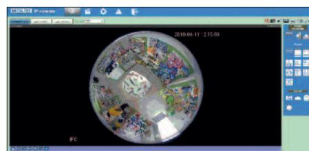
Для устранения эффекта "рыбьего глаза" используется цифровая обработка изображения в видеокамере. Она выполняет ряд задач:
