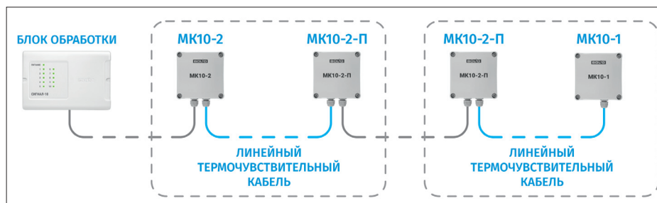
Рис. 3. Схема подключения ЧЭ к БО
