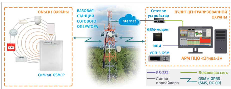
Рис. 2. Мониторинг объектов с системой охраны "Антарес" на базе комплекса "Эгида-3"
