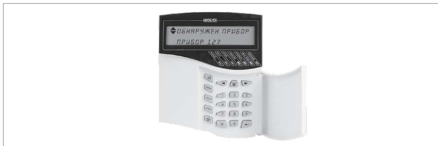
Рисунок 1. Индикатор пульта «С2000М» с соответствующим сообщением
