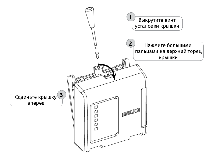
Рисунок 35. Снятие крышки изделия
