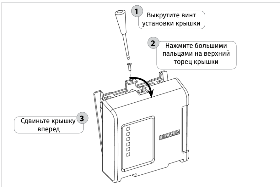
Рисунок 25. Снятие крышки прибора
