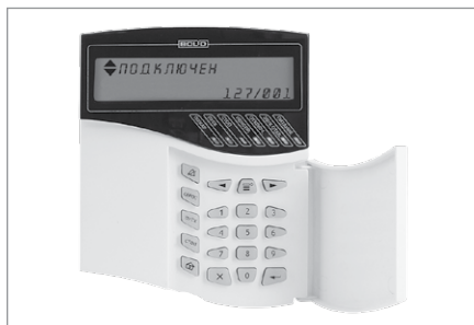
Рисунок 1. Индикатор пульта «С2000М» с соответствующим сообщением
