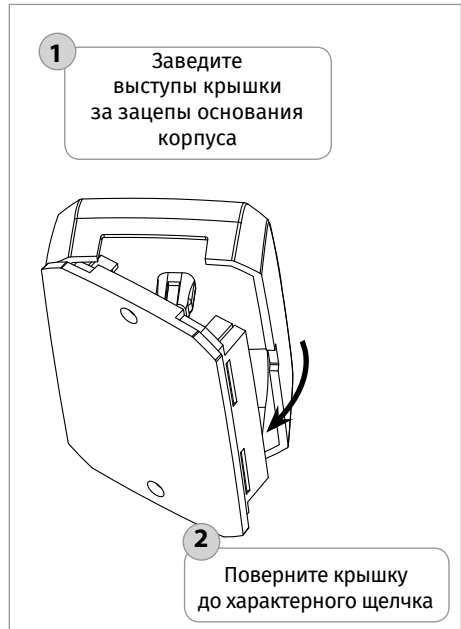
Рисунок 23. Установка крышки прибора
