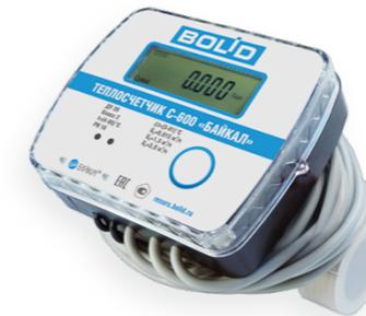
Теплосчётчики BOLID-С600-Байкал предназначены для вычисления тепловой энергии путём измерения объёма и температуры теплоносителя в прямом или обратном трубопроводах в закрытых водяных системах отопления. Могут быть использованы как автономно, так и в составе АСКУЭ «Ресурс». В зависимости от модификации оборудованы проводным интерфейсом RS-485, модемом LoRaWAN или импульсным выходом. Тип преобразователя расхода — ультразвуковой.
