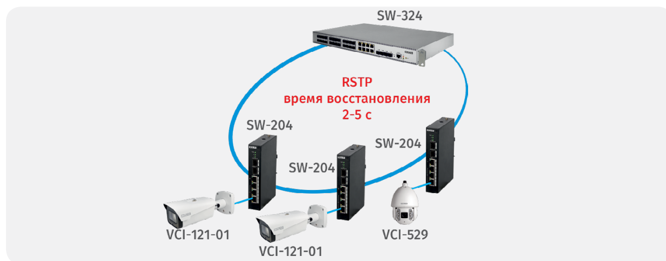
Рисунок 81. Примеры кольцевых топологий для построения периметральных систем видеонаблюдения
