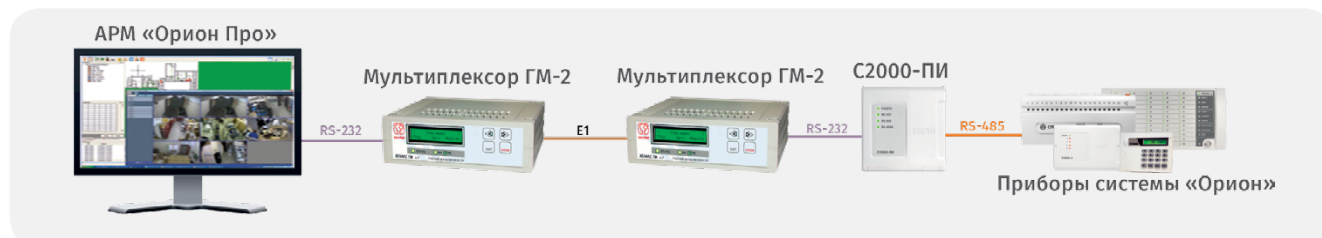
Рисунок 108. Структурная схема использования мультиплексора «ГМ-2» с АРМ «Орион Про»
