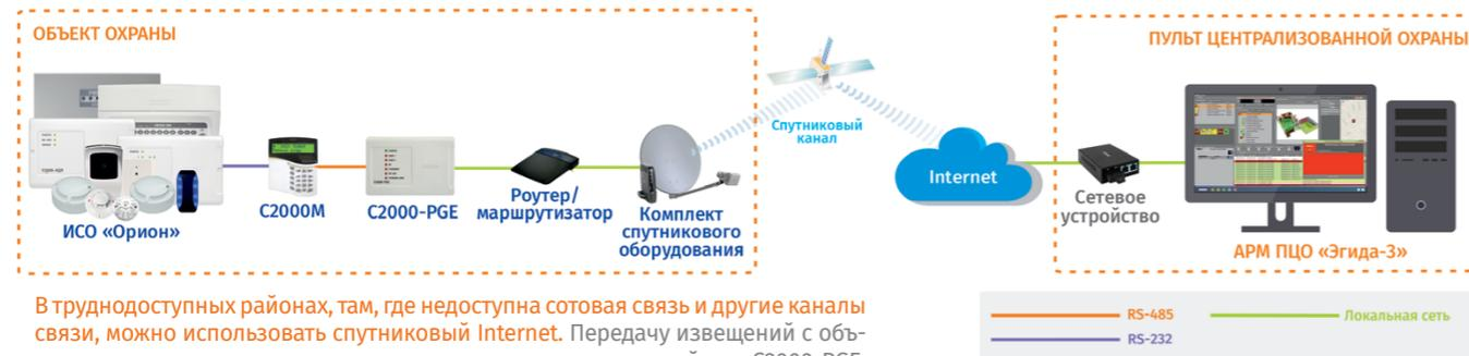
В труднодоступных районах, там, где недоступна сотовая связь и другие каналы связи, можно использовать спутниковый Internet. Передачу извещений с объектов в данном примере можно вести через оконечное устройство C2000-PGE, которое подключается к спутниковому ресиверу. Объём трафика при передаче извещений с небольших объектов может быть в пределах 5-8 Мб в месяц.
