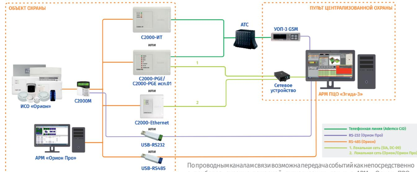
По проводным каналам связи возможна передача событий как непосредственно с приборов охранно-пожарной сигнализации, так и с АРМ «Орион ПРО». Применение прямого подключения приборов по RS232/Ethernet позволяет вести управление объектами охраны, получать значения запылённости, уровня питающего напряжения и другие параметры.
