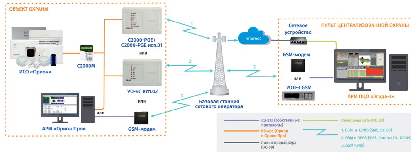
Применение приборов производства «Болд» обеспечивает выбор каналов связи и протоколов, применение любого из них обеспечивает передачу более 150 различных событий с точностью до входа, адресного извещателя. По каналам сотовой связи возможно управление приборами ЗАО НВП «Болд».
