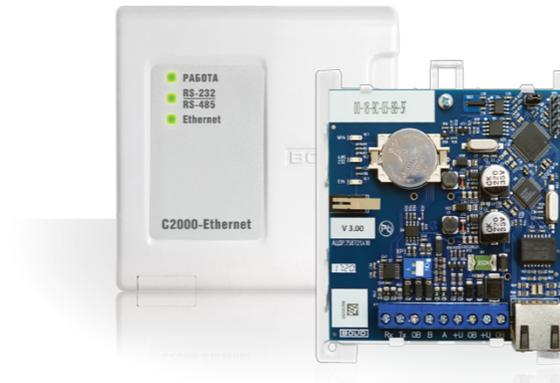
Для охраны объектов с ИСО «Орион». Передача извещений по локальной сети в протоколе «Орион» или «Орион Про». Управление приборами по локальной сети
