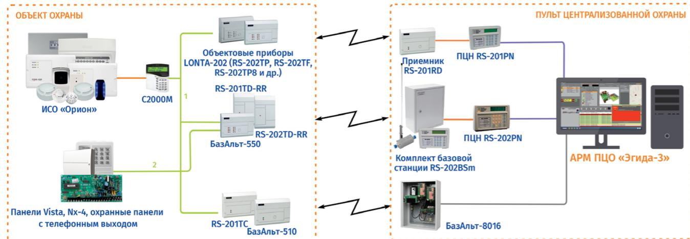
Радиоканальный способ передачи извещений позволяет передавать извещения от приборов интегрированной системы Орион с точностью до шлейфа или адресного извещателя. Через радиоканальные системы передачи извещений производства компании «Альтоника» есть возможность вывести сигналы с объектов, оснащённых сторонним оборудованием.
