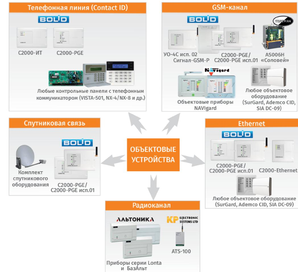
К ПУЛЬТОВЫМ УСТРОЙСТВАМ относятся различные приёмники, пульта, модемы, которые осуществляют приём извещений, их конвертирование и передачу на АРМ ПЦО «Эгида-3».
