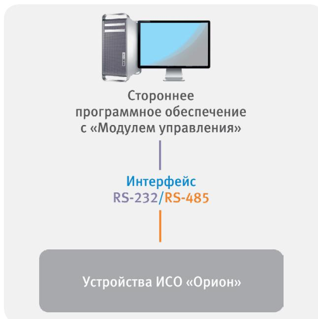
Рисунок 98. Интеграция с устройствами посредством «Модуля управления»
