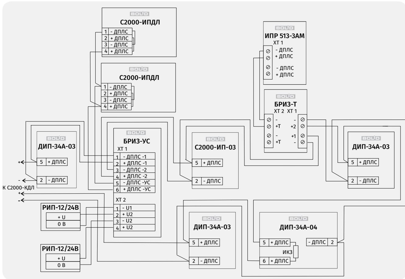
Рисунок 40. Схема подключения адресных извещателей в ДПЛС с топологией «кольцо»
