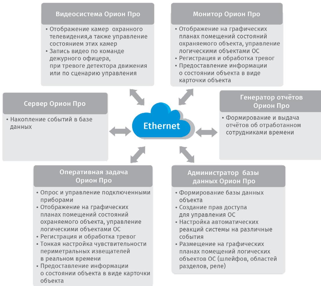
Рисунок 54. Функционал модулей программного обеспечения АРМ «Орион Про»
