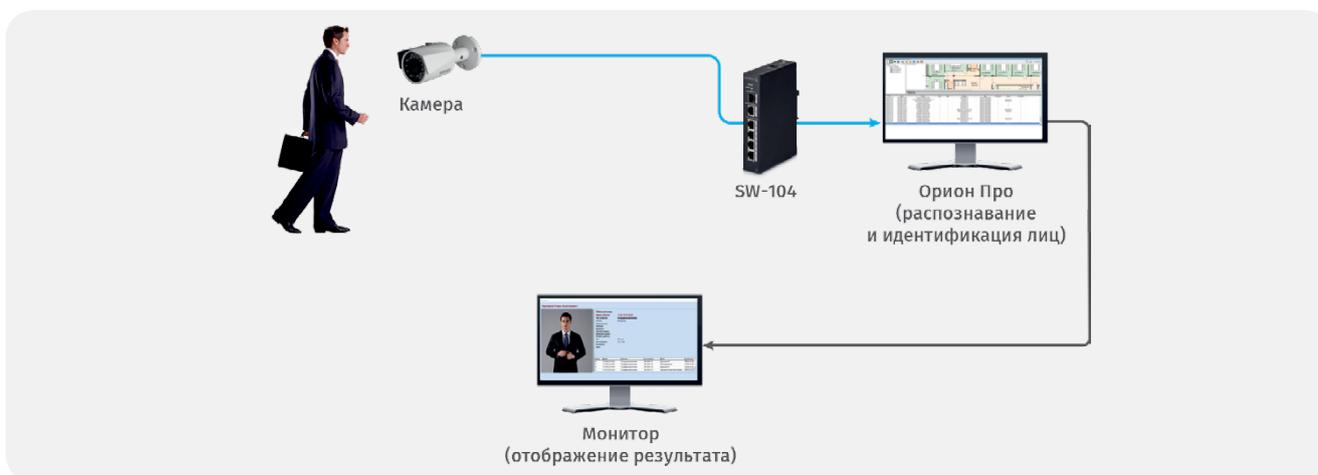
Рисунок 92. Схема работы идентификации и распознавания лиц
