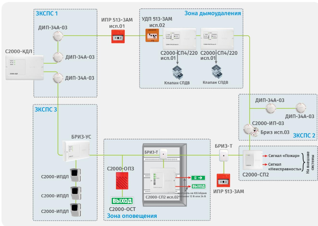
Рисунок 39. Структурная схема организации ДПЛС в СПА
