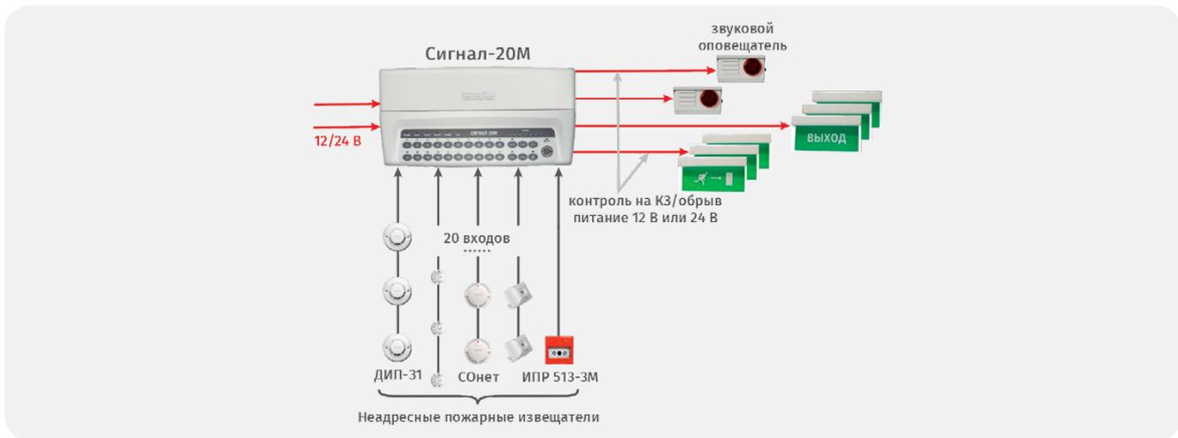
Рисунок 14. СОУЭ 1-го и 2-го типа на базе ППКУП «Сигнал-20М»
