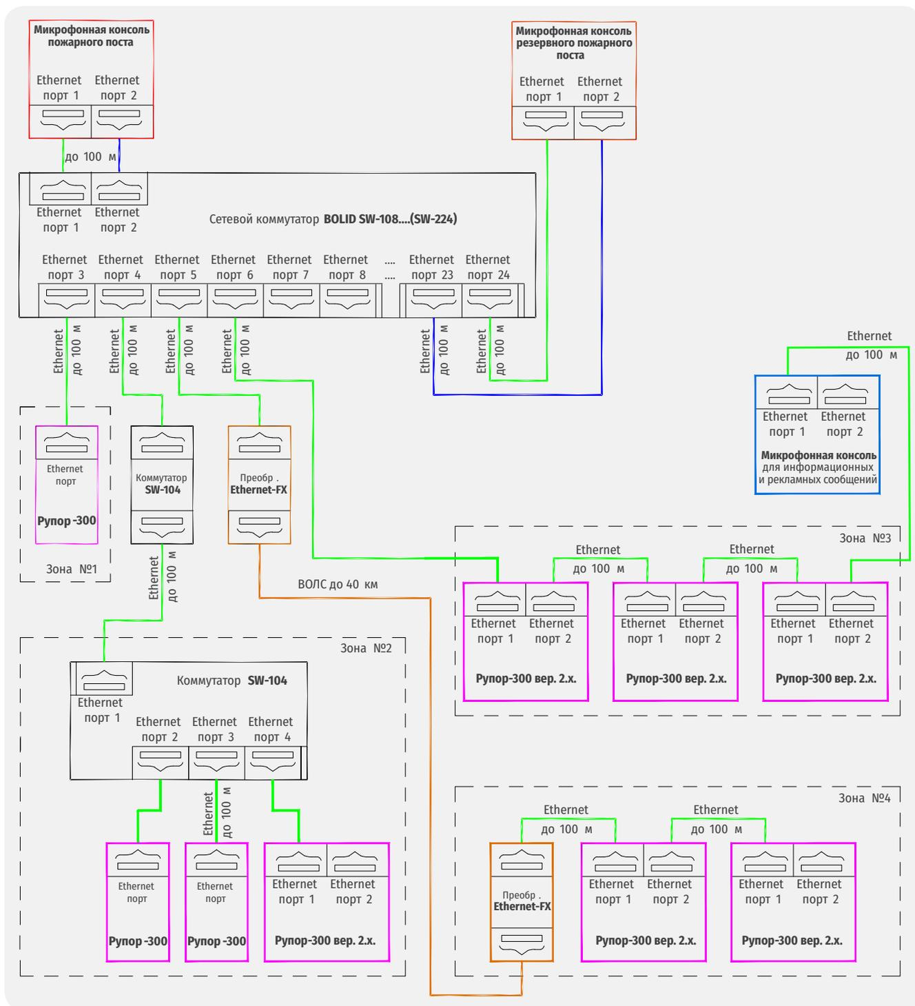
Рисунок 41. Организация ЛВС для «Микрофонной консоли-20» и «Рупор-300»
