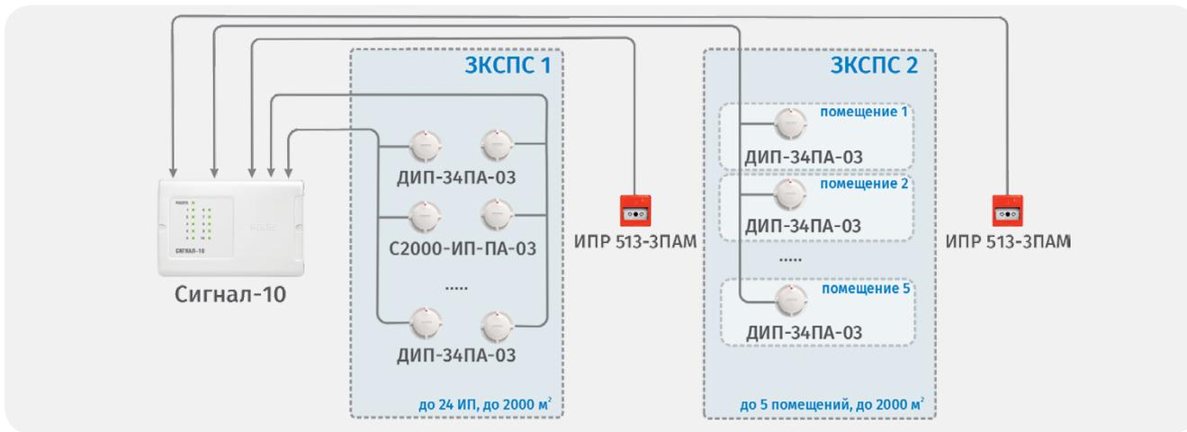
Рисунок 3. Организация линий и ЗКСПС в адресно-пороговых СПС
