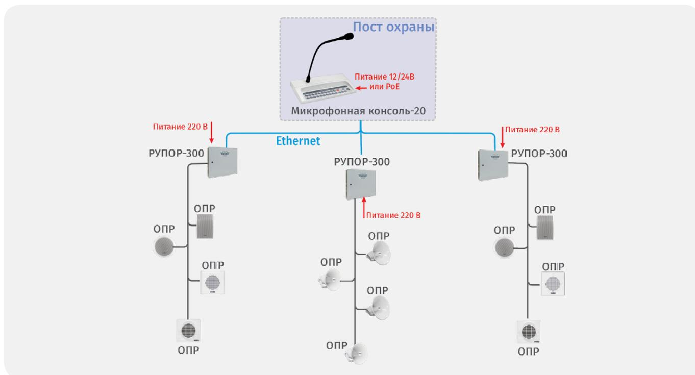
Рисунок 55. Система оповещения для больших объектов
