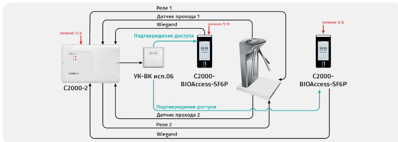
Рисунок 68. Использование C2000-BioAccess-SF6P в качестве биометрических считывателей
