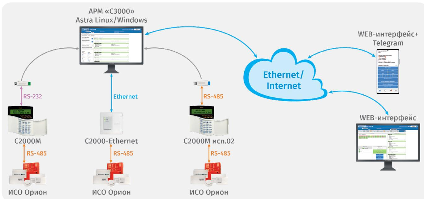
Рисунок 53. Организация управления ОС при помощи АРМ «С3000»
