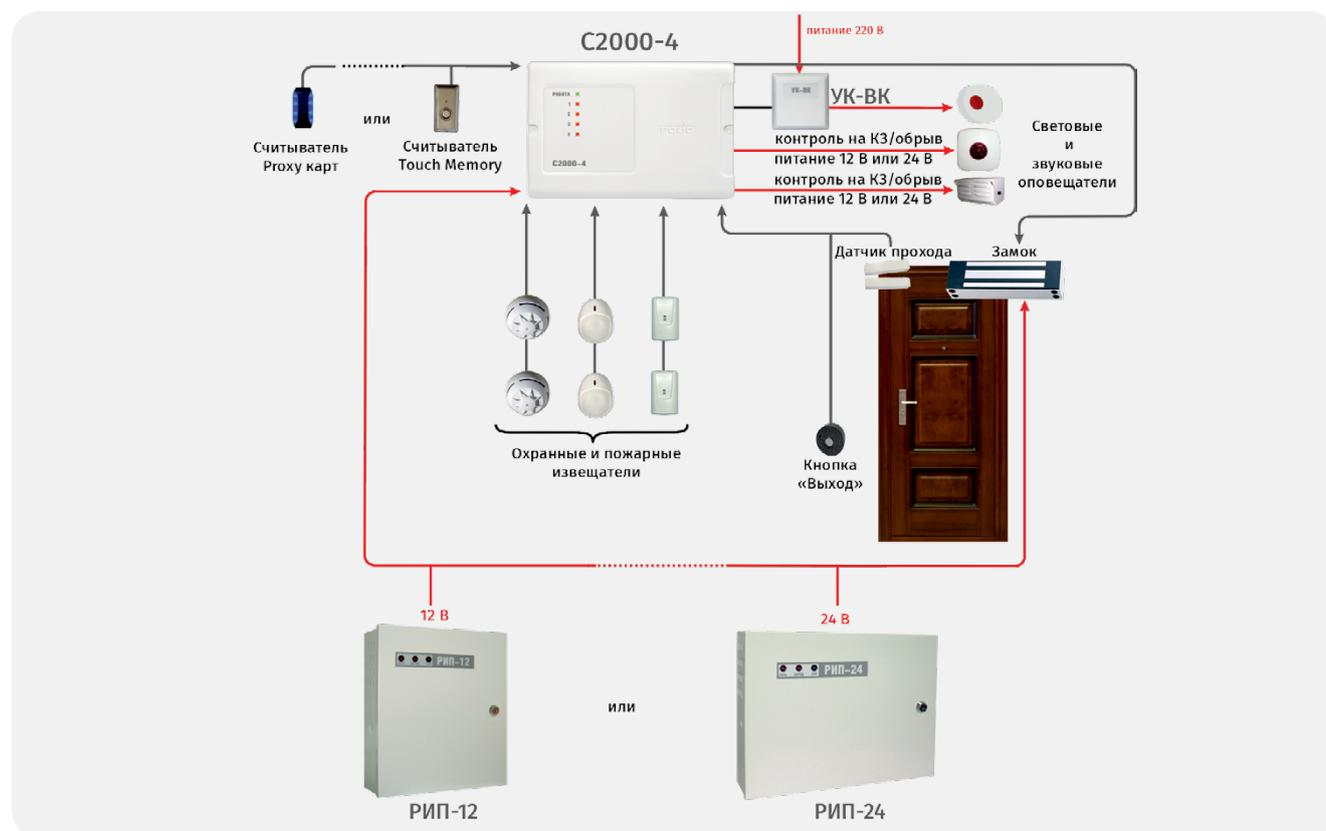
Рисунок 65. «С2000-4» с функционалом контроля доступа
