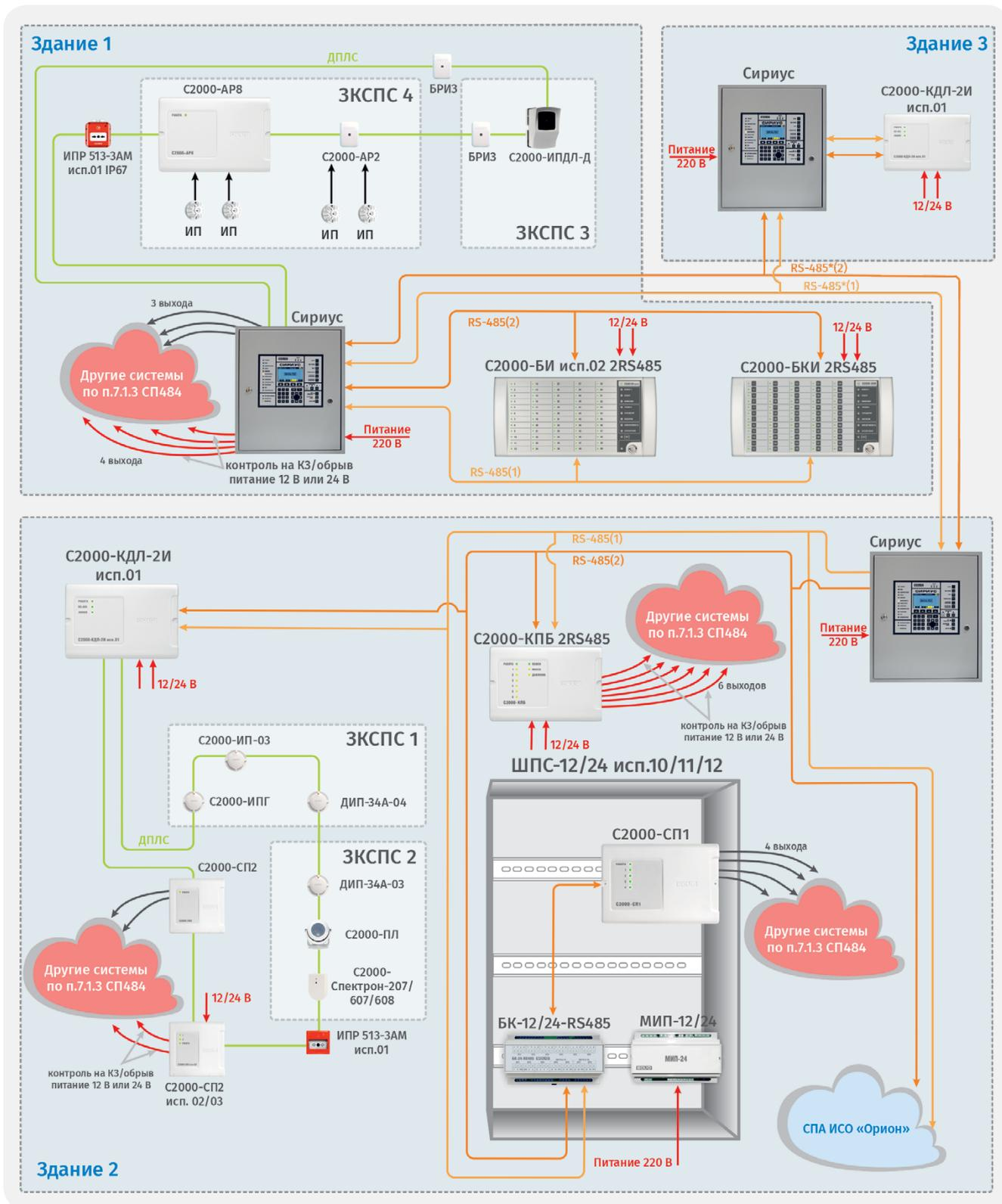
Рисунок 11. Адресно-аналоговая СПС на базе ППКУП «Сириус»
