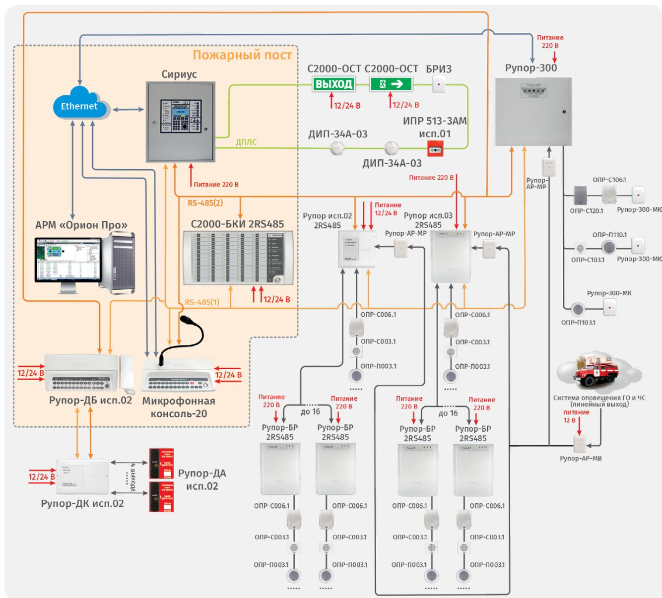
Рисунок 17. СОУЭ 4-5 типов на базе ППКУП «Сириус»
