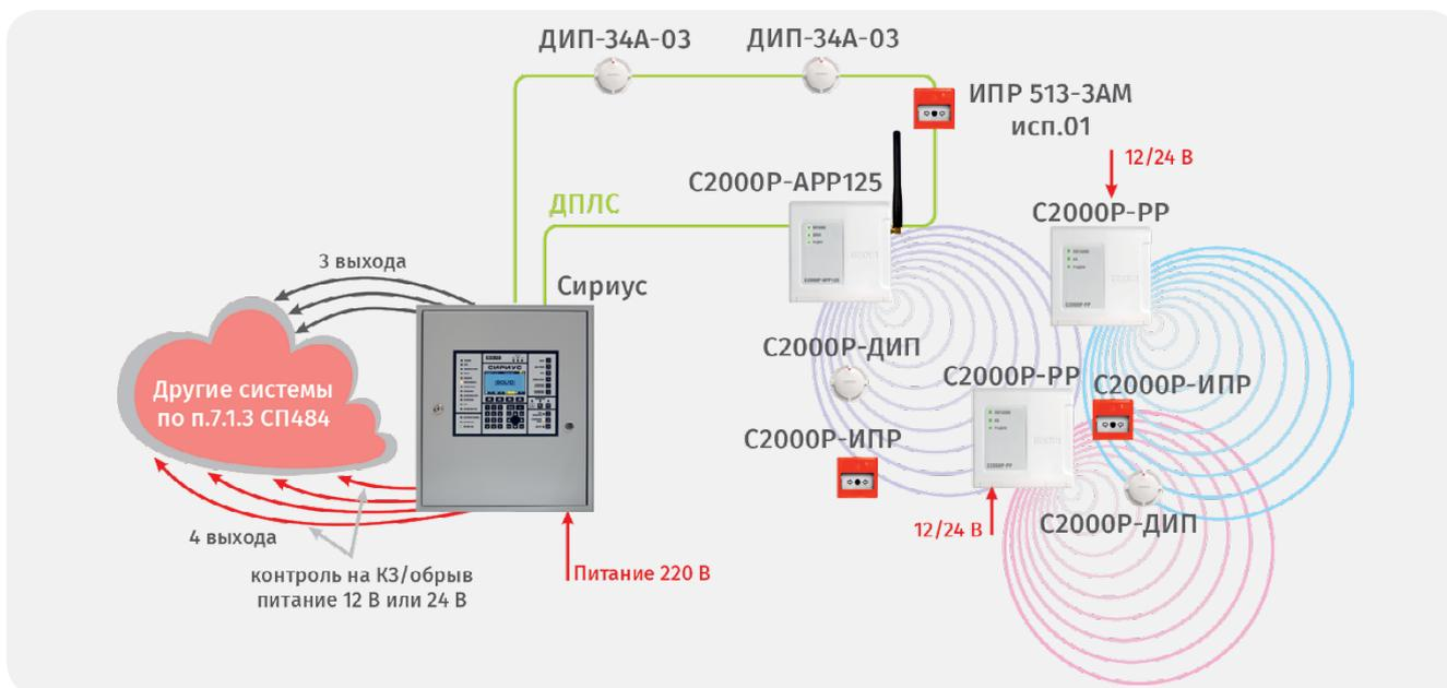
Рисунок 12. Радиоканальное расширение адресно-аналоговой системы пожарной сигнализации
