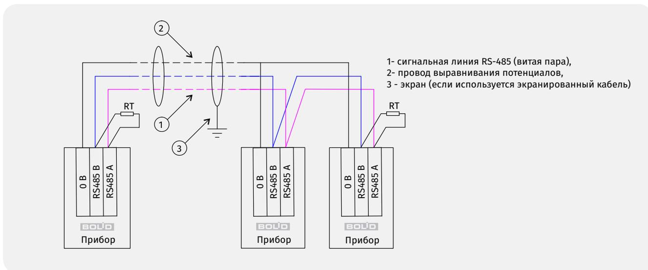
Рисунок 111. Схема подключения приборов к магистральному интерфейсу RS-485
