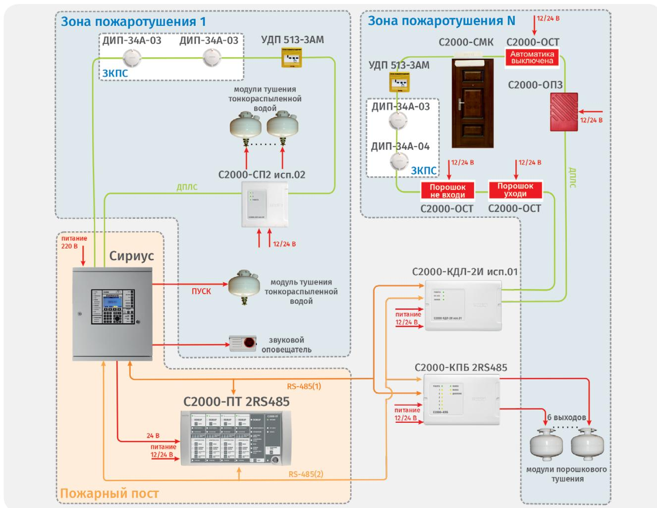
Рисунок 21. Реализация модульных установок порошкового и водяного тушения
