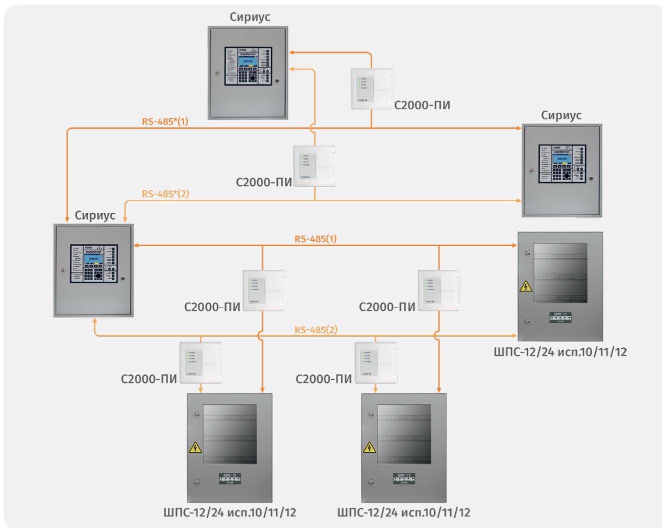
Рисунок 35. Структурная схема сети RS-485 с топологией «звезда» при помощи повторителей интерфейса
