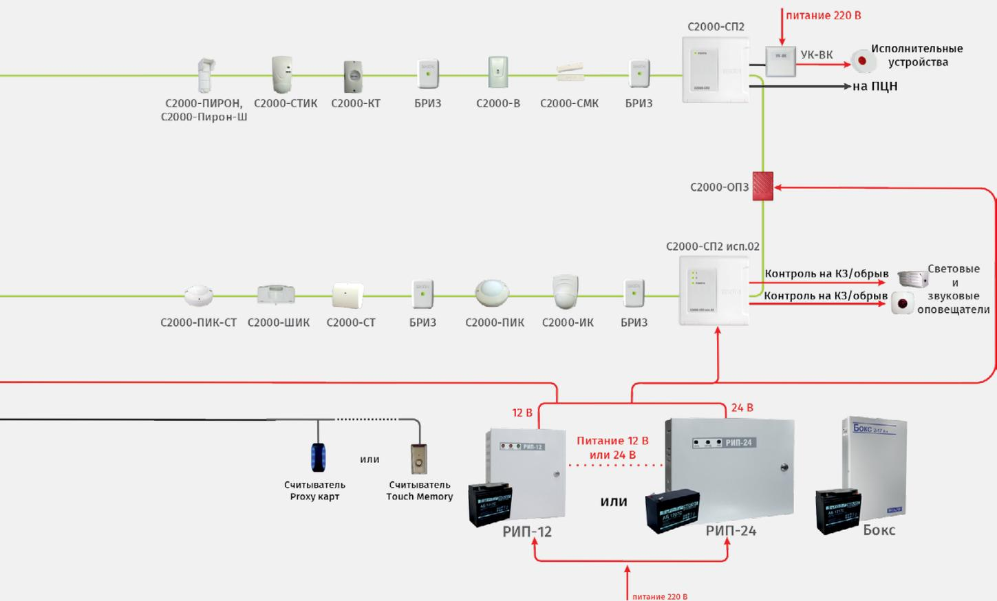
Рисунок 49. Адресная система охранной сигнализации
