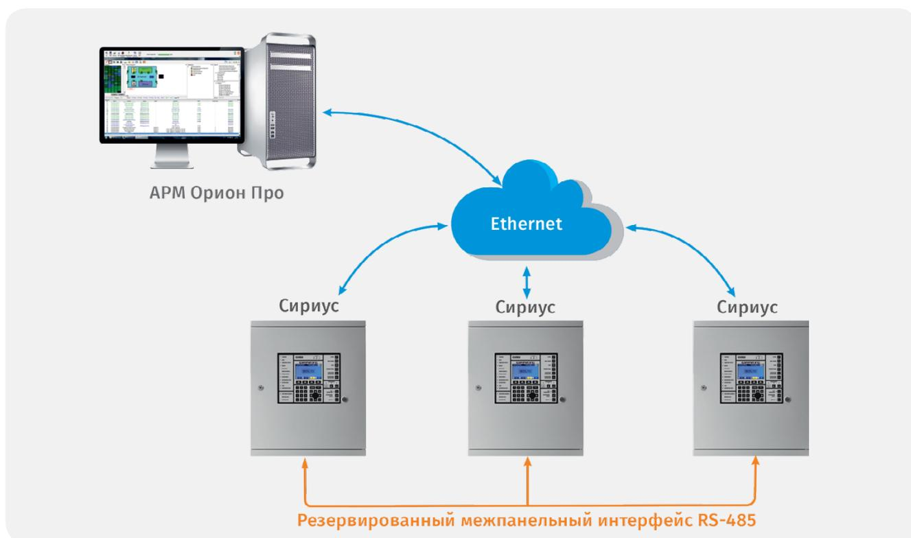
Рисунок 30. Подключение нескольких ППКУП «Сириус» к АРМ «Орион Про»
