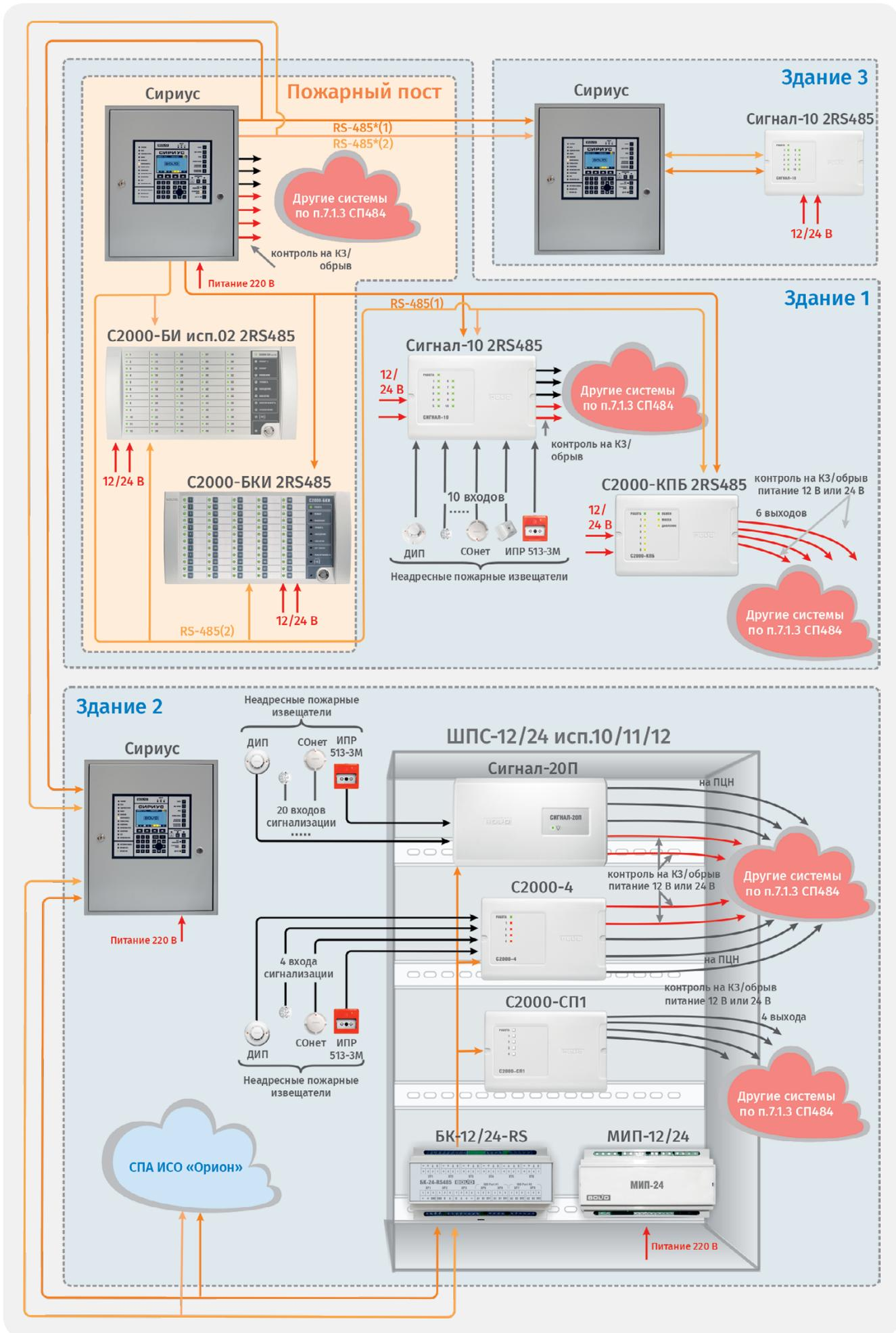
Рисунок 8. Распределенная неадресная СПС на базе ППКУП «Сириус»
