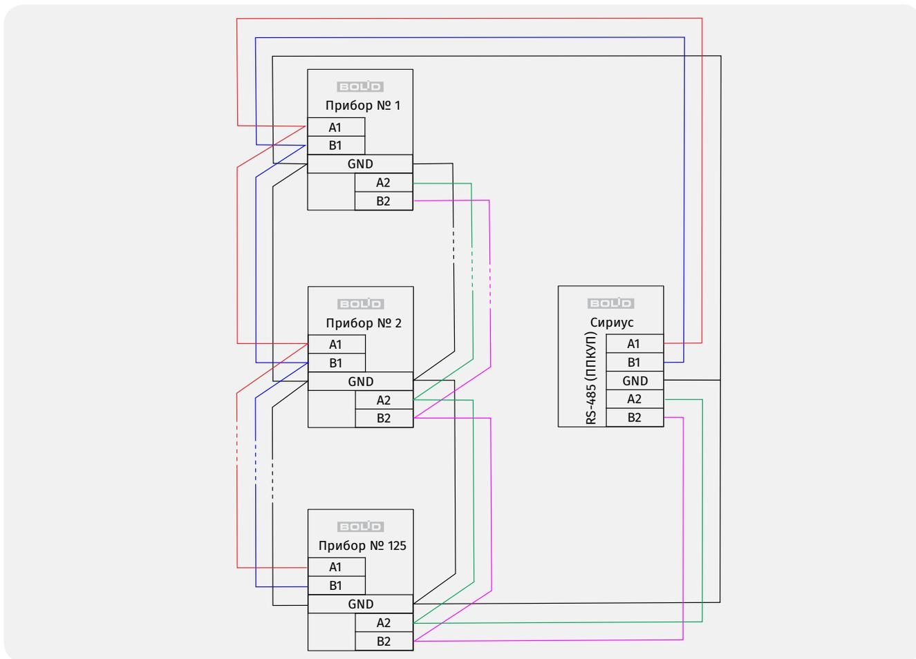
Рисунок 33. Структурная схема резервированного RS-485 интерфейса с топологией «кольцо»
