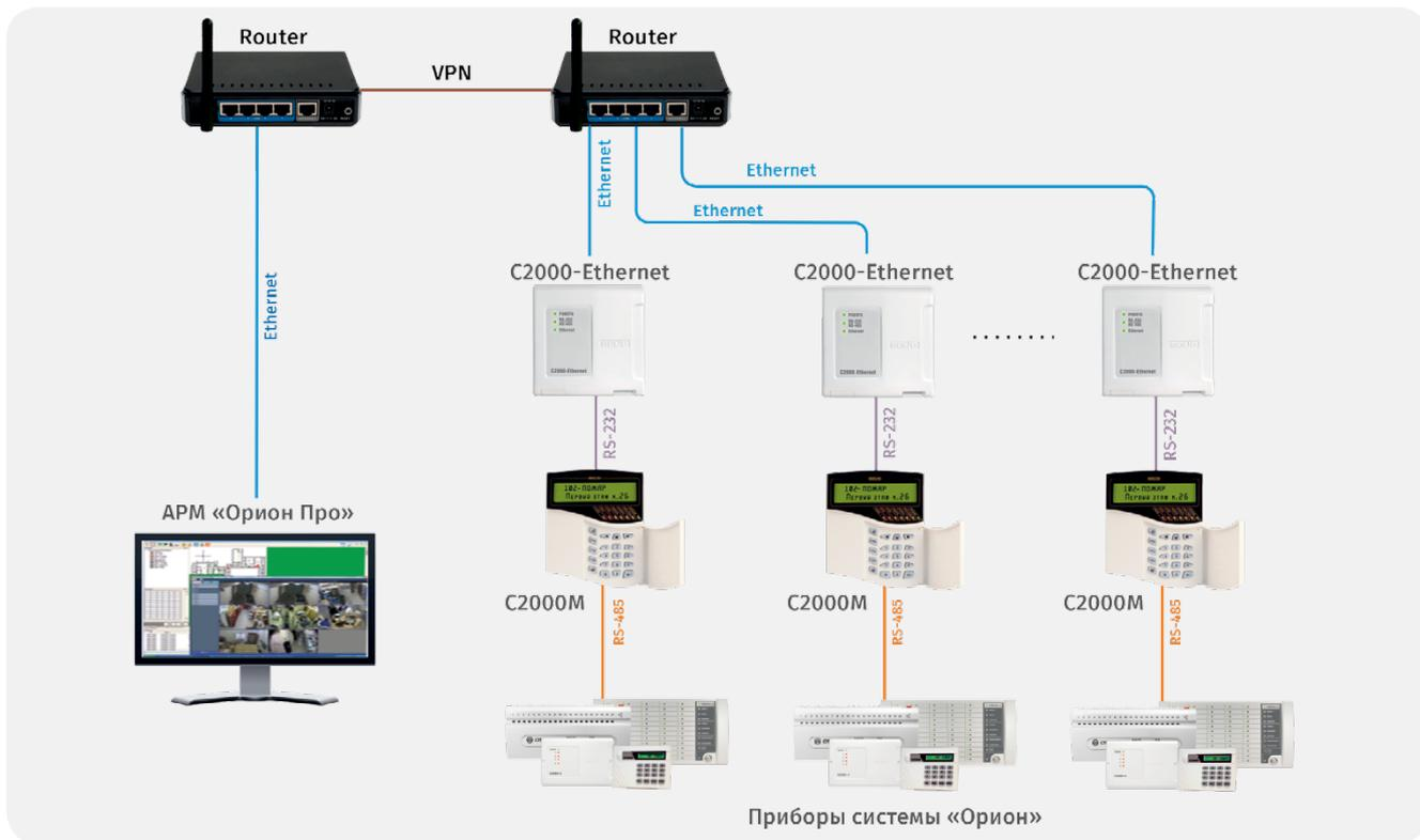
Рисунок 105. Пример использования «C2000-Ethernet» в глобальных сетях
