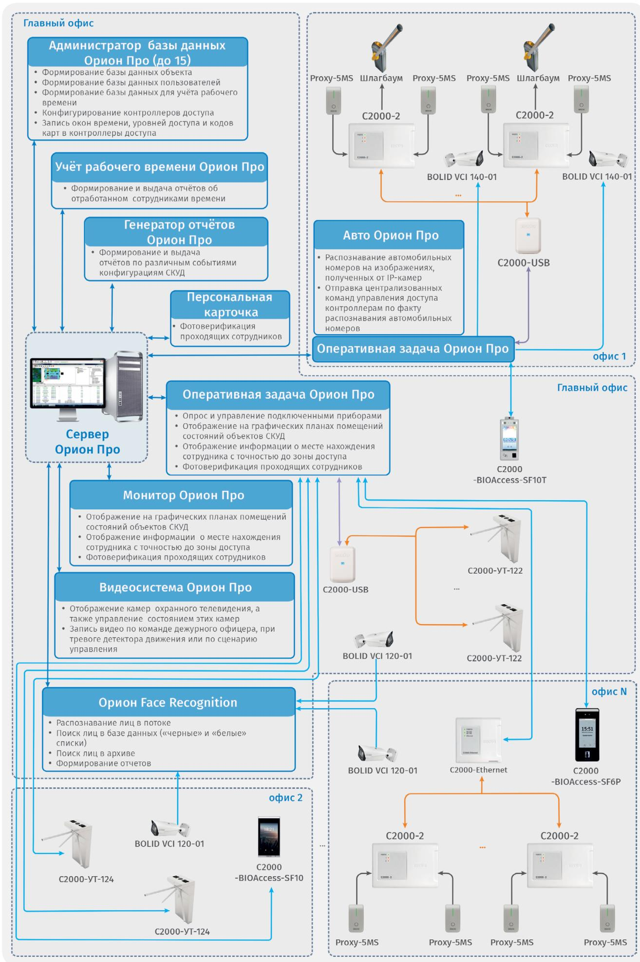
Рисунок 71. Системы контроля доступа с программным обеспечением
