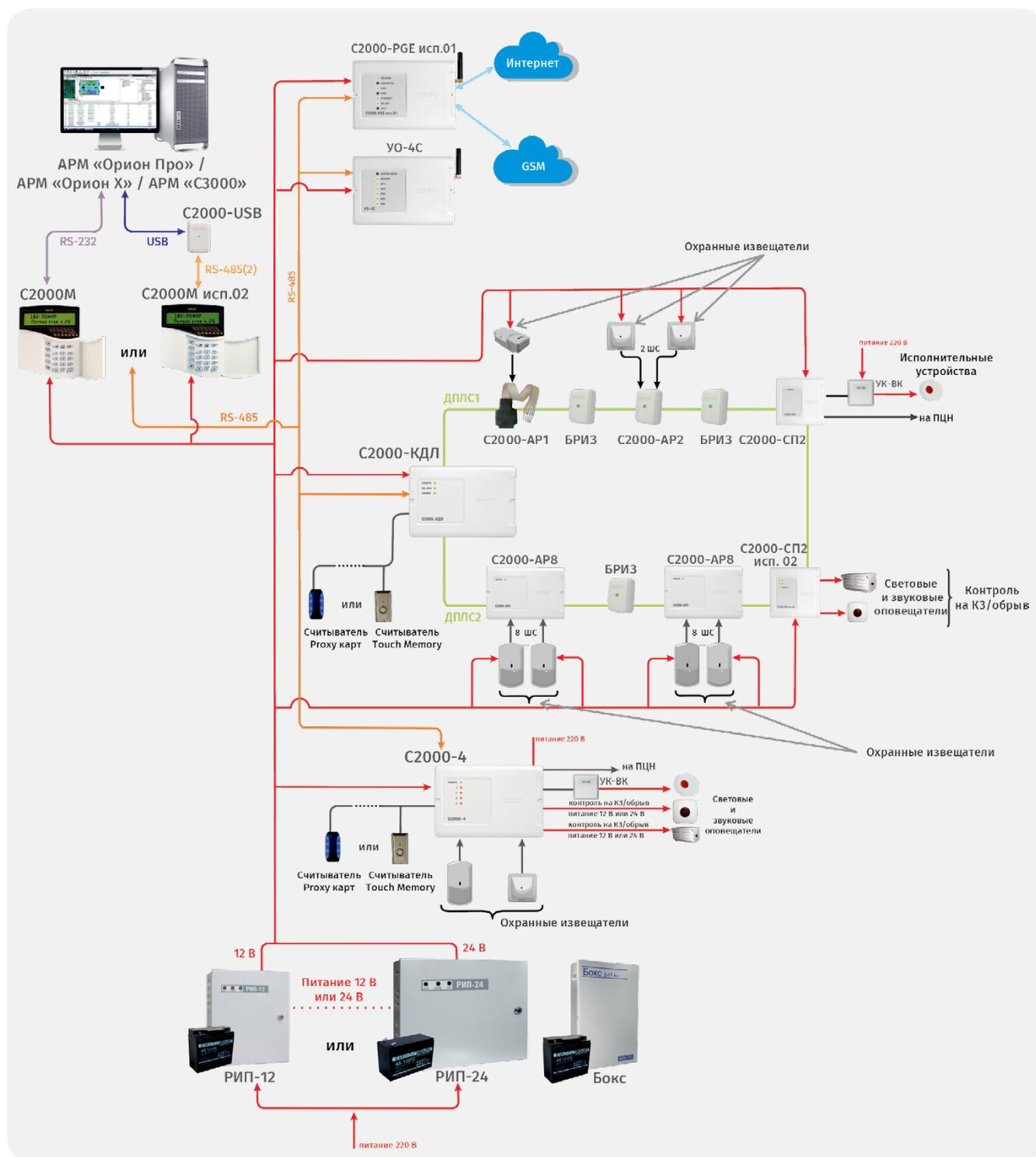
Рисунок 51. Комбинированная система охранной сигнализации
