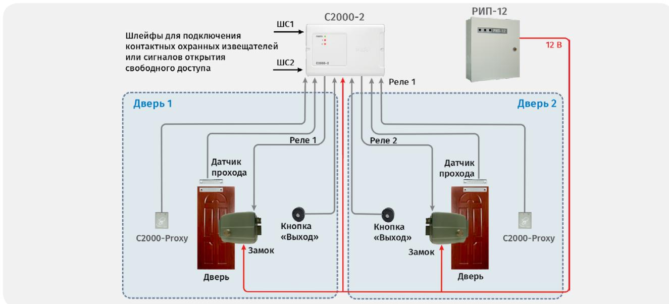
Рисунок 58. Режим работы «Две двери на вход»
