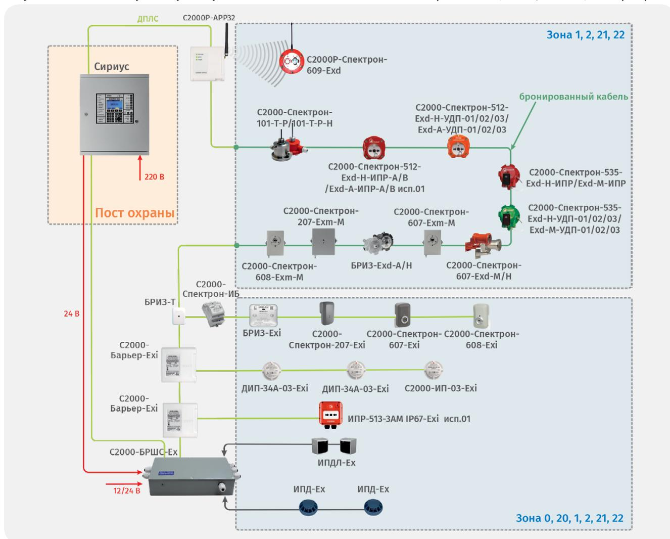
Рисунок 27. Расширение адресно-аналоговой СПС для взрывоопасных объектов
