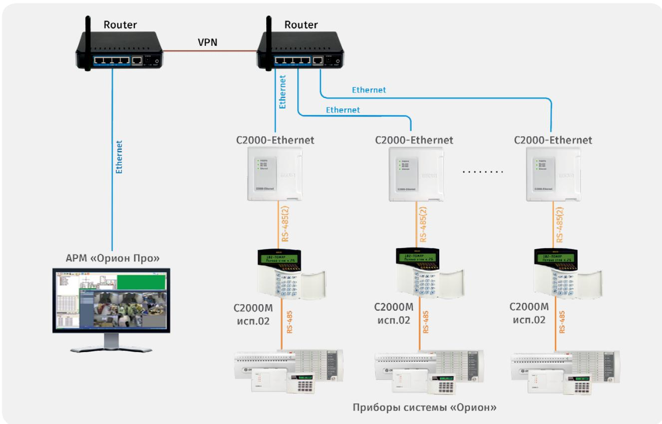
Рисунок 123. Пример использования «С2000-Ethernet» в глобальных сетях
