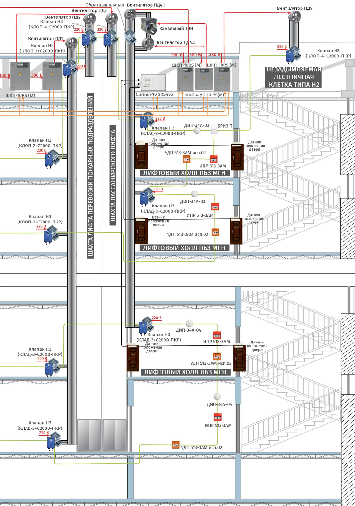
Рисунок 18. СПДВ в ИСО «Орион»
