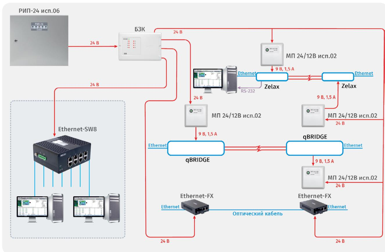
Рисунок 74. Электропитание сетевого каналобразующего оборудования
