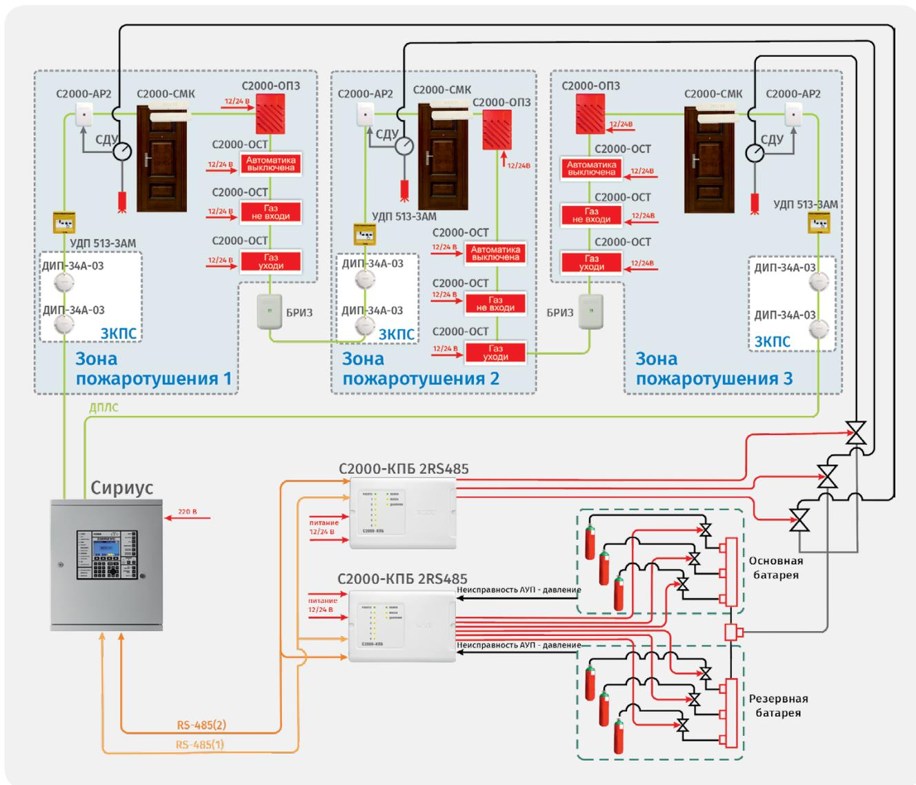
Рисунок 20. Реализация централизованных АВГПТ с резервной батареей
