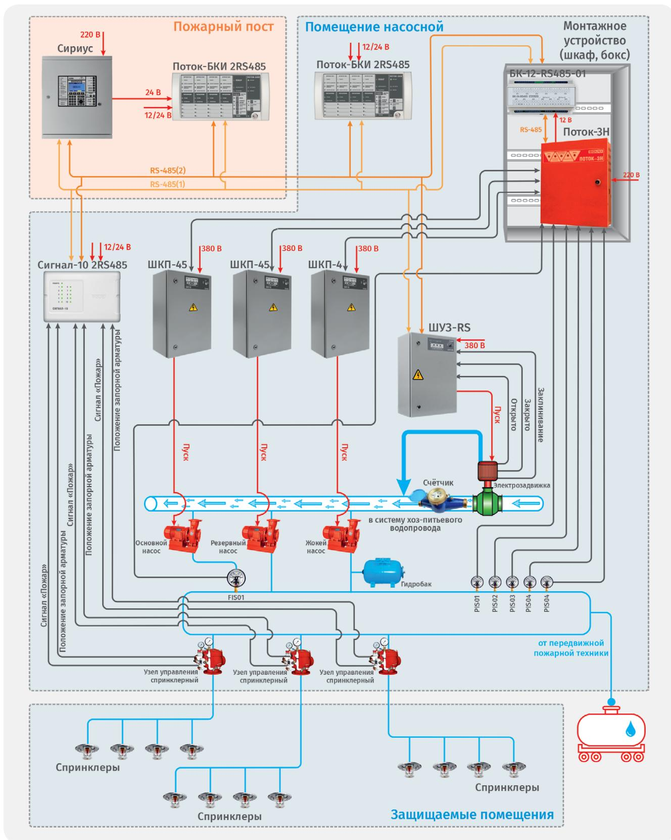
Рисунок 25. Автоматическая установка пожаротушения с тремя спринклерными секциями на направления (перед СПЖ).
