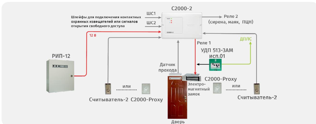
Рисунок 59. Режим работы «Одна дверь на вход/выход»
