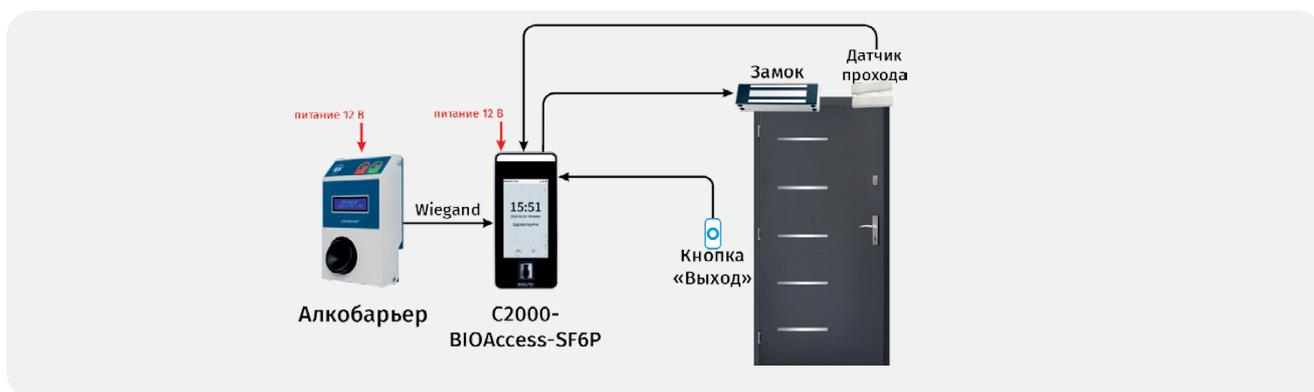
Рисунок 67. Подключение алкотестеров к биометрическим контроллерам
