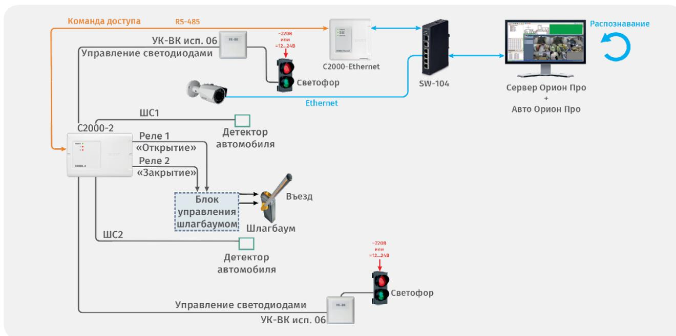
Рисунок 91. Видеонаблюдение с определением номеров на транспортном КПП
