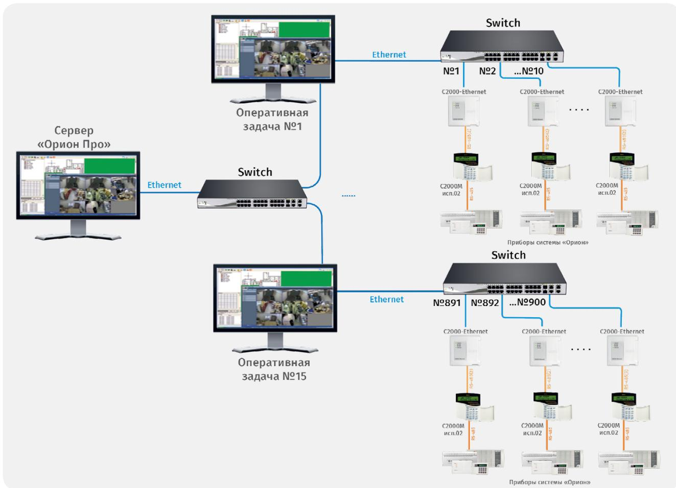
Рисунок 124. Пример построения системы с использованием «C2000-Ethernet» на 900 объектах
