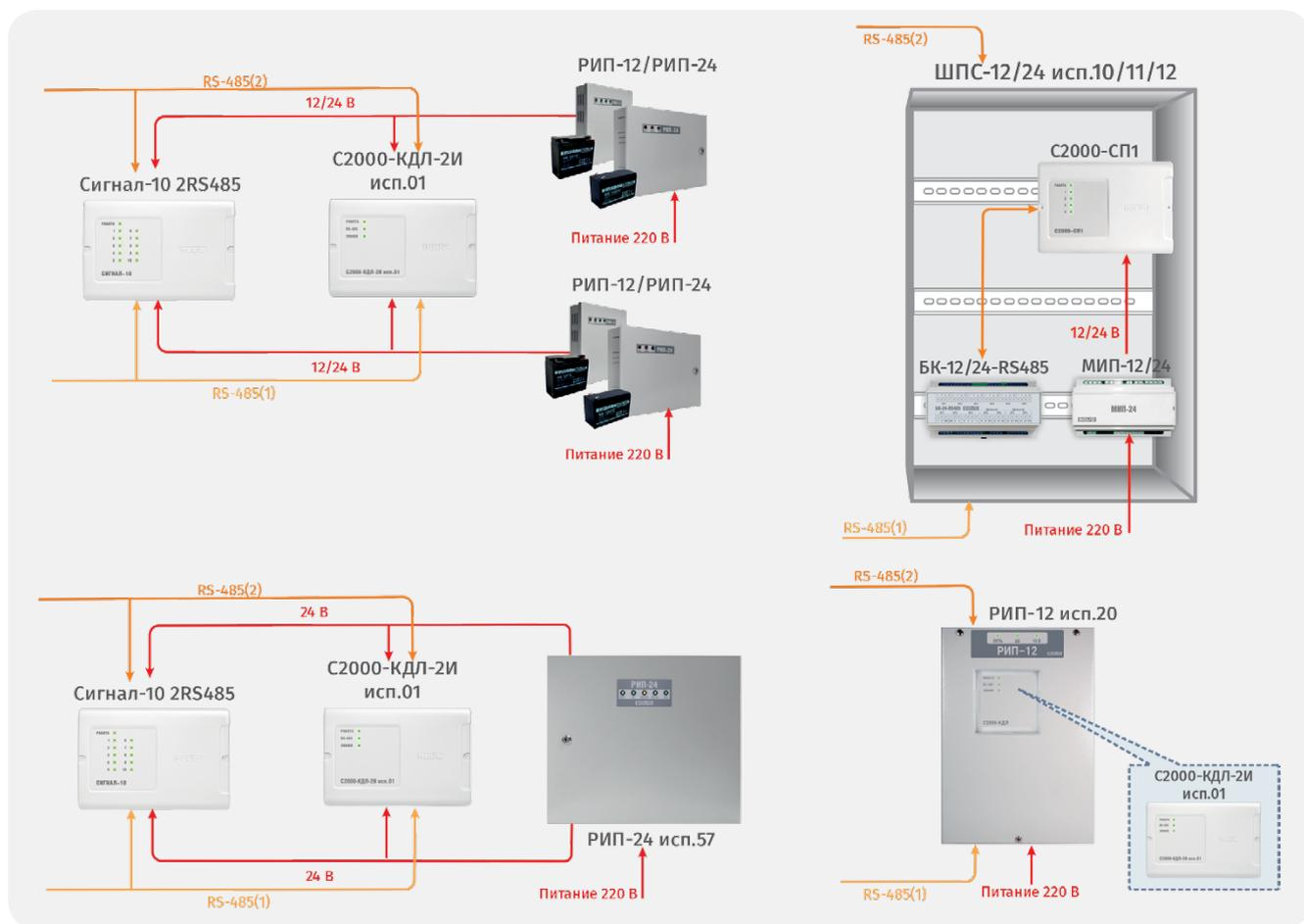
Рисунок 13. Организация электропитания блоков СПА
