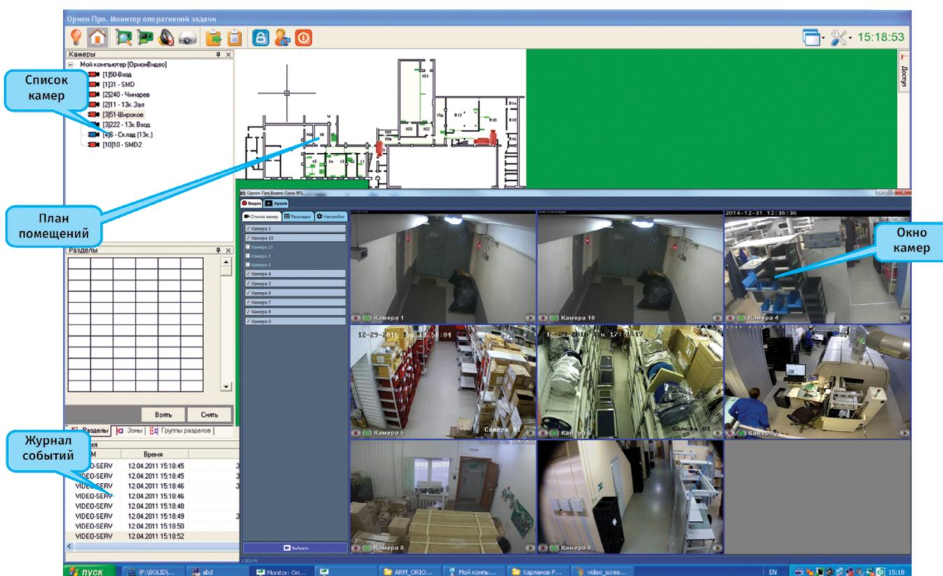
Рисунок 79. Пример рабочего интерфейса АРМ Орион Про
