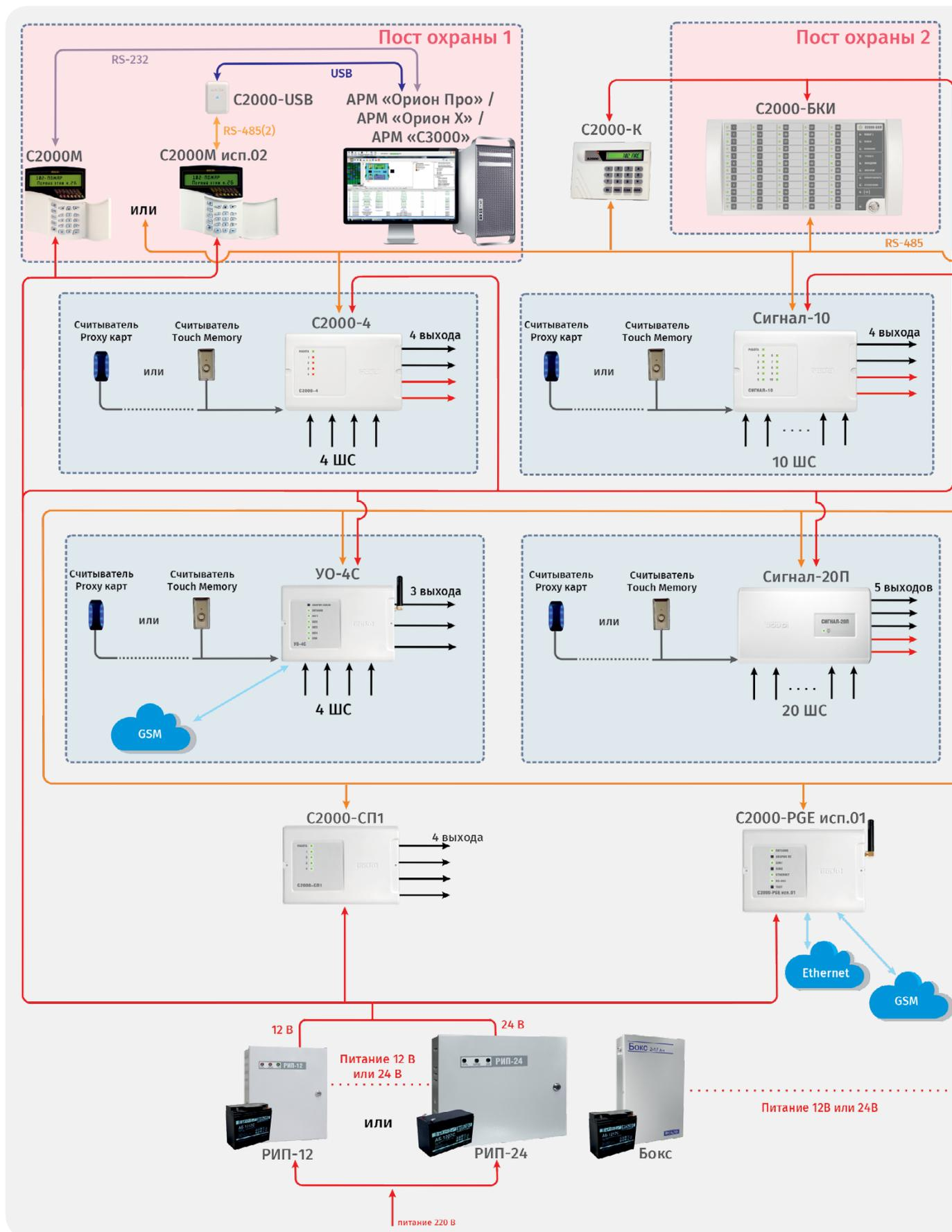
Рисунок 48. Система охранной сигнализации с сетевым контроллером
