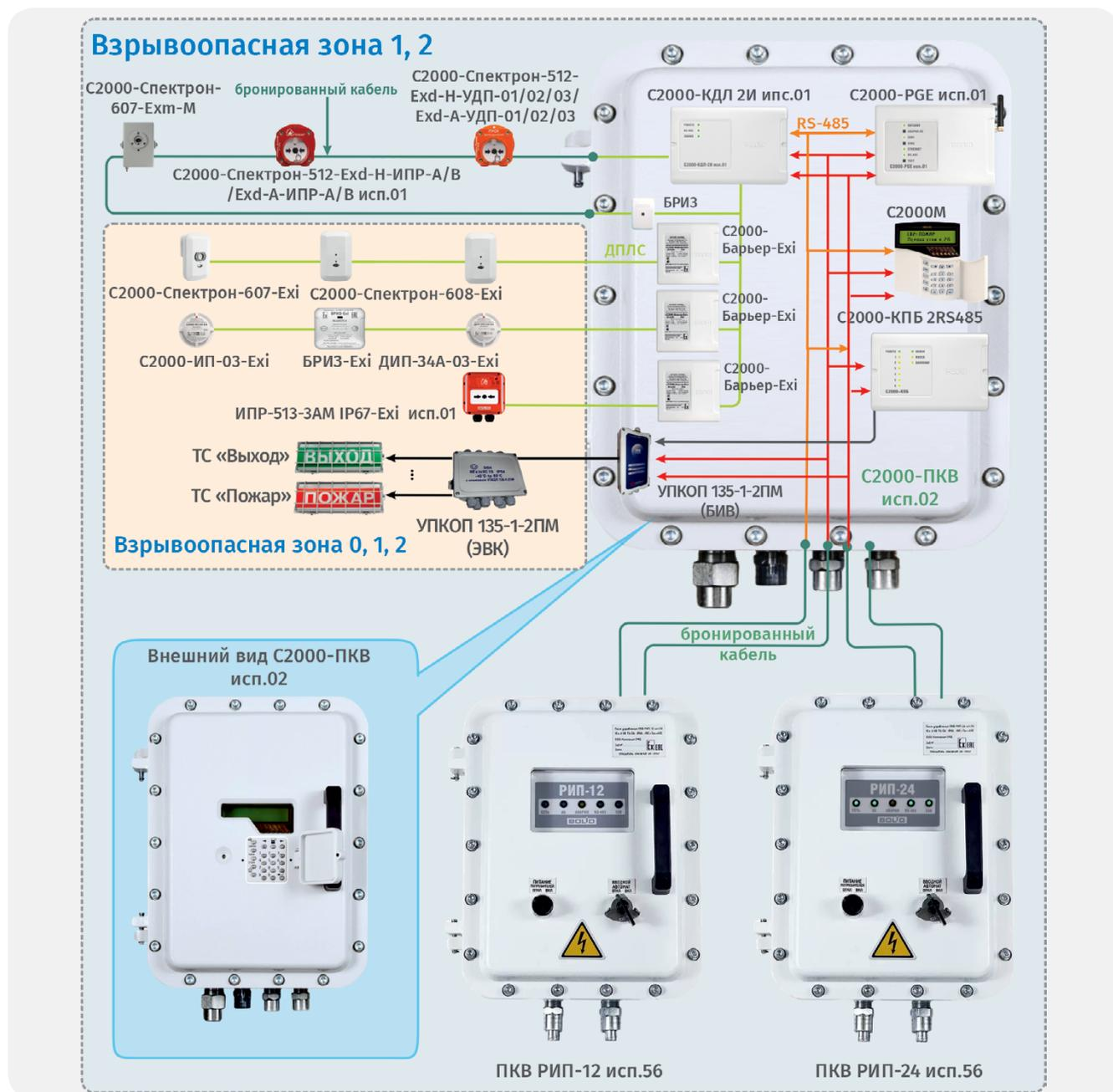
Рисунок 28. Размещение оборудования СПА внутри взрывоопасной зоны
