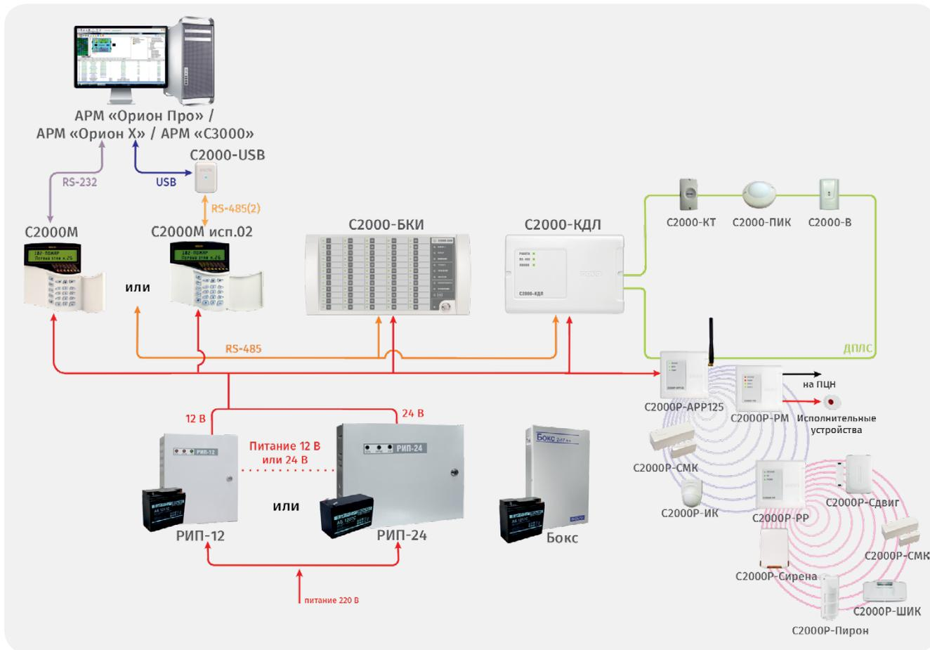
Рисунок 50. Адресная радиоканальная система на основе «C2000P-APP125»
