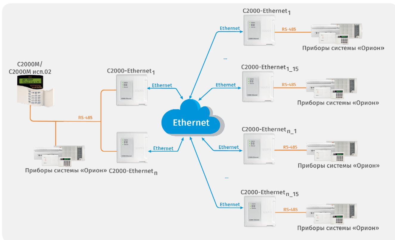
Рисунок 114. Структурная схема использования «C2000-Ethernet» с «C2000M»
