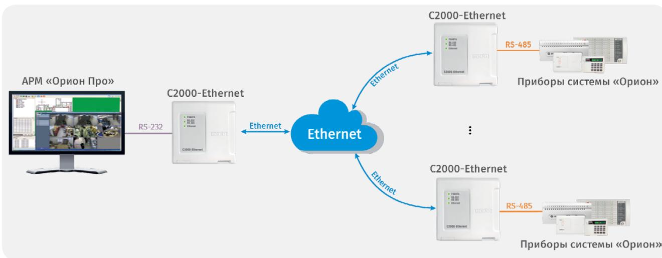
Рисунок 119. Типовая схема работы «С2000-Ethernet» по протоколу «Орион»
