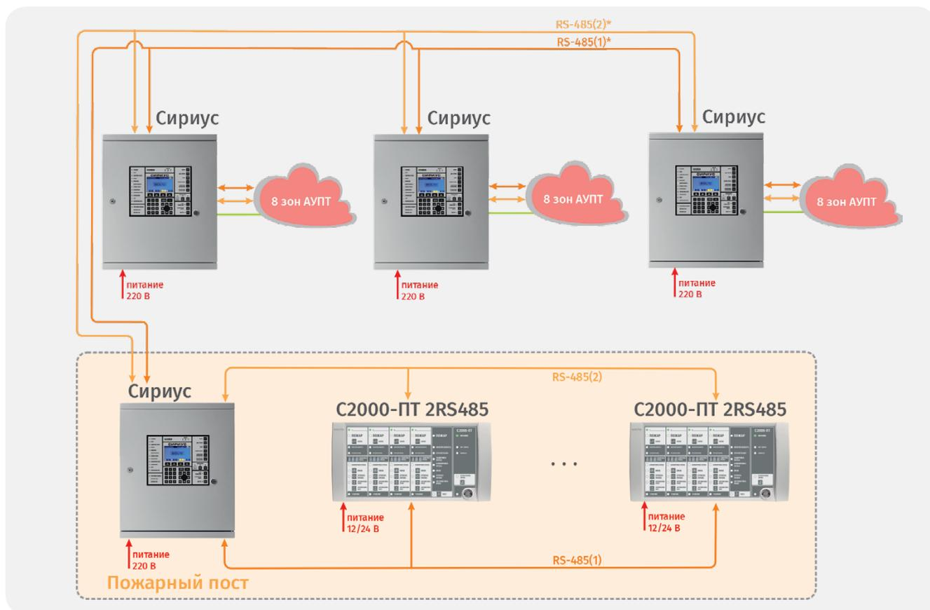
Рисунок 22. Реализация систем пожаротушения большого числа зон
