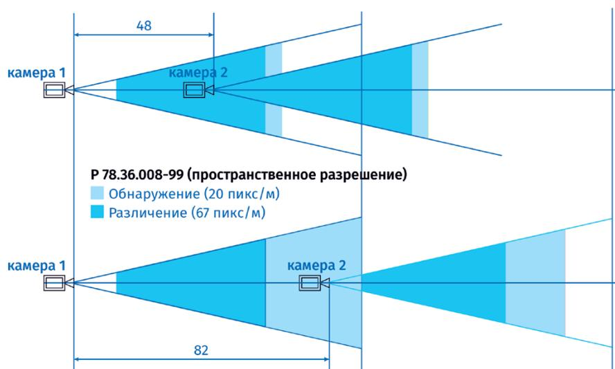
Рисунок 88. Варианты перекрытий зон обзора на протяженном периметре
