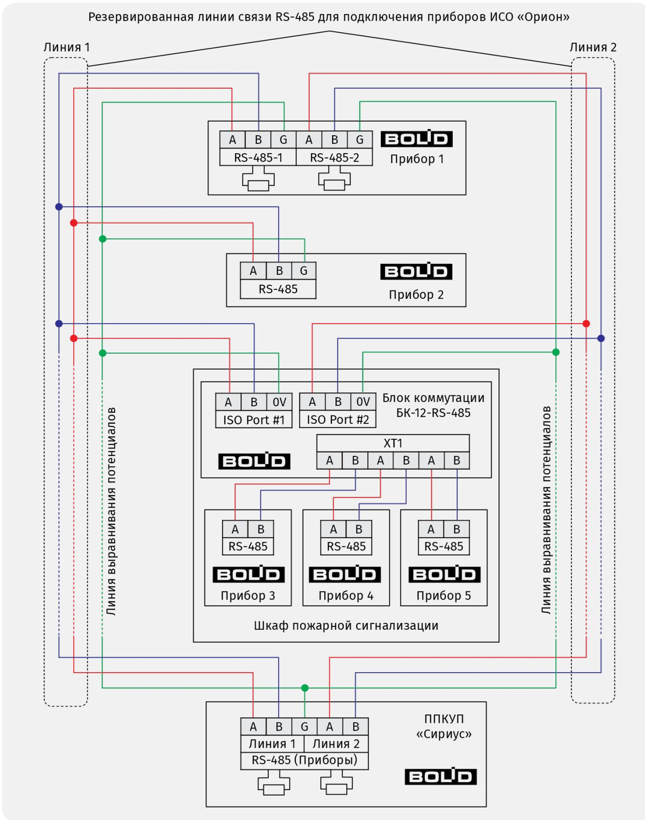
Рисунок 31. Схема подключения приборов к резервированному интерфейсу RS-485
