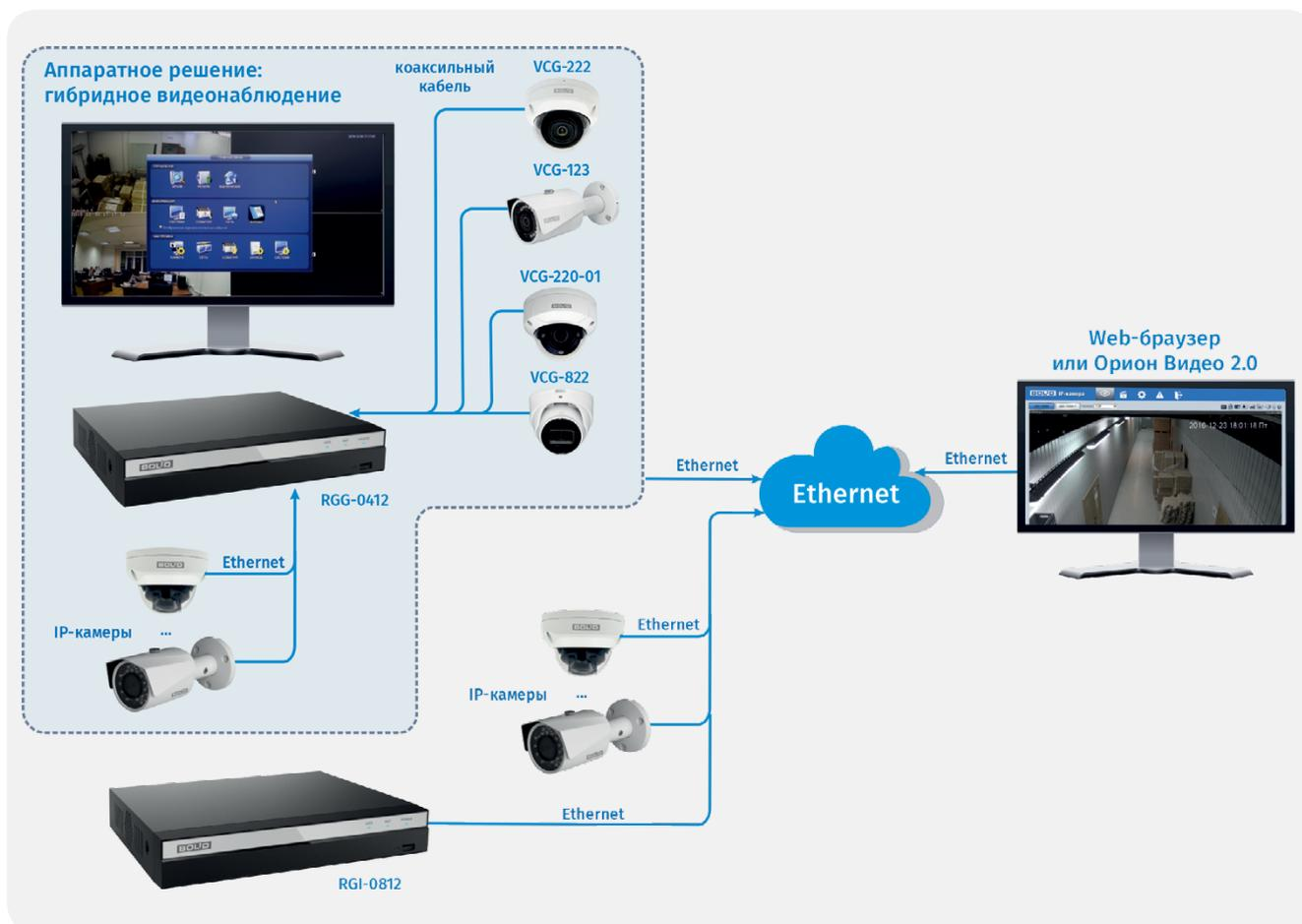
Рисунок 77. Локальная система видеонаблюдения на основе аппаратного решения
