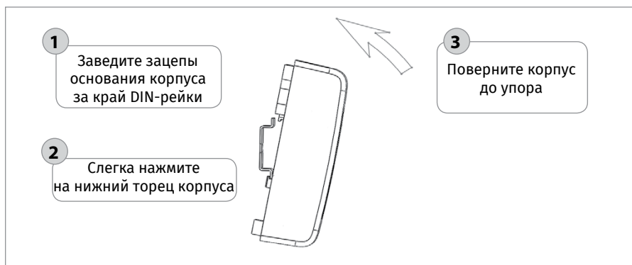
Рисунок 20. Порядок установки прибора на DIN-рейку
