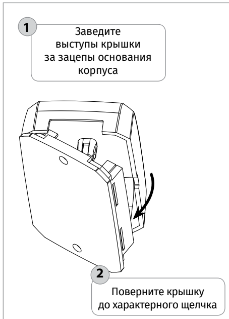
Рисунок 23. Установка крышки прибора
