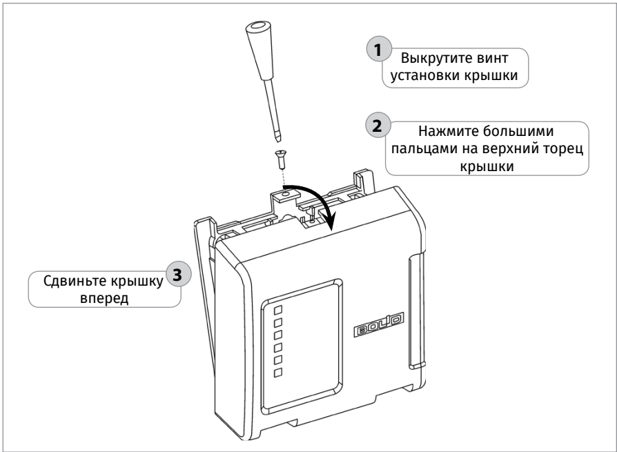
Рисунок 35. Снятие крышки изделия
