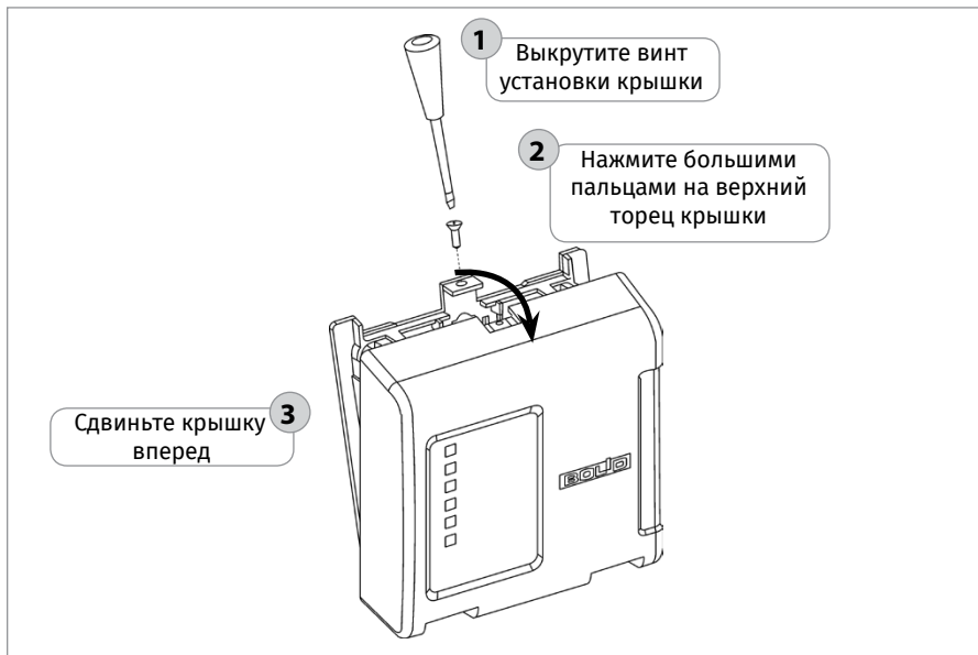
Рисунок 25. Снятие крышки прибора
