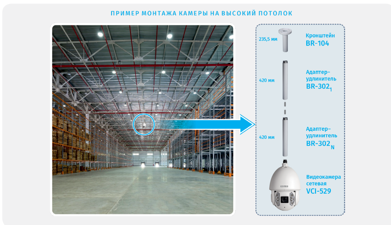
Рисунок 83. Пример монтажа поворотной камеры с помощью адаптеров-удлинителей
