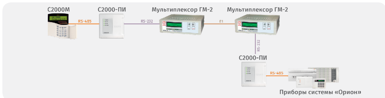
Рисунок 110. Структурная схема использования мультиплексора «ГМ-2» с пультом «С2000М»
