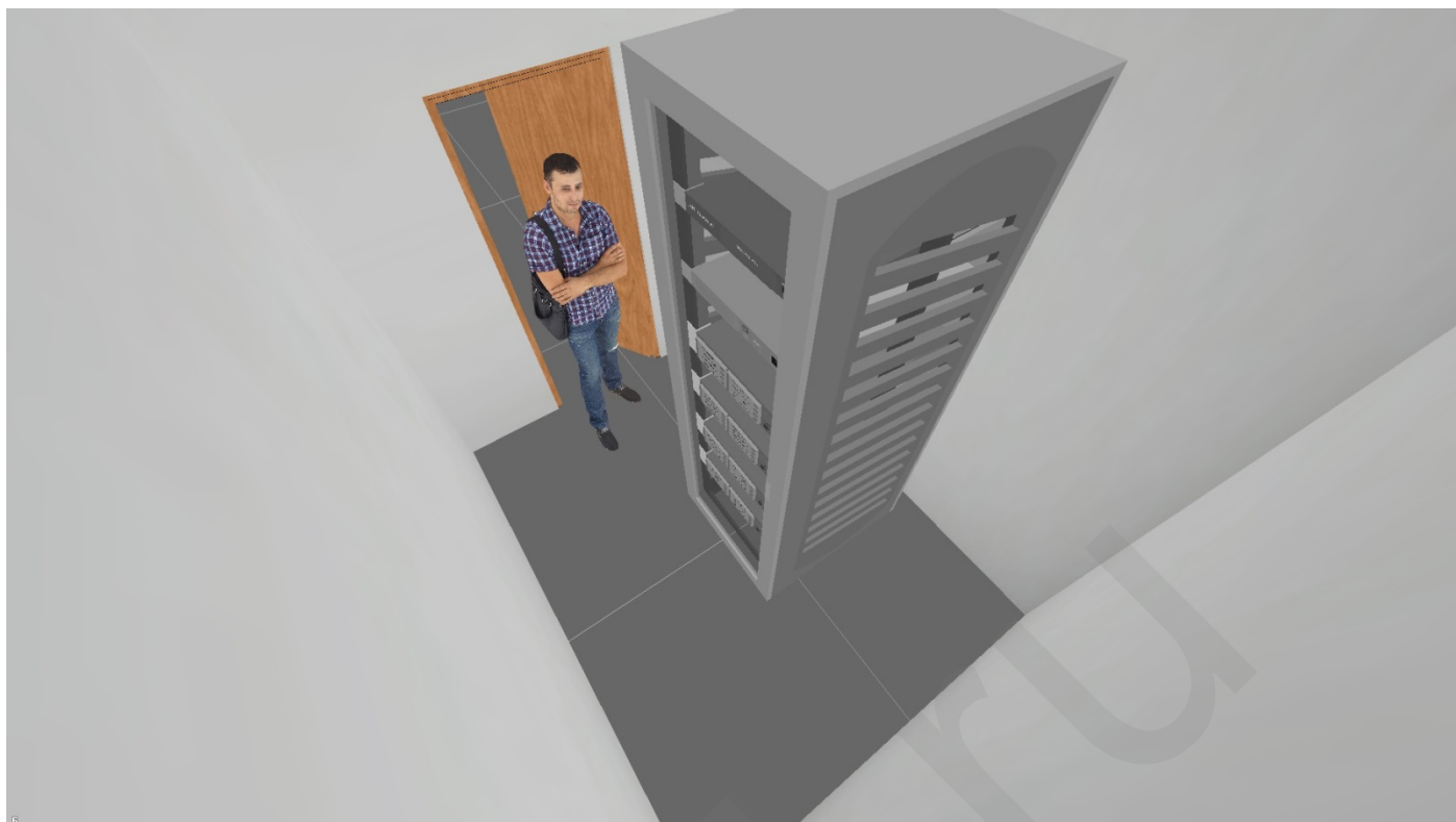
Центральное оборудование размещается в 19" серверной стойке
