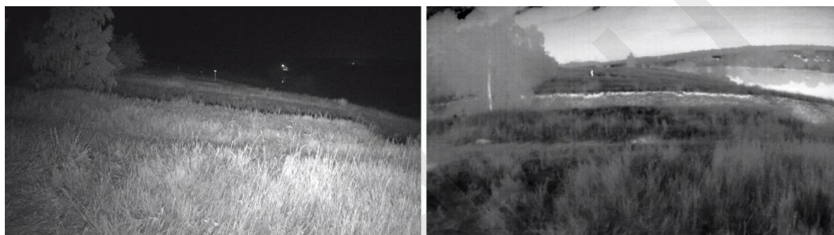
Слева – камера с ИК-подсветкой, справа – тепловизор
