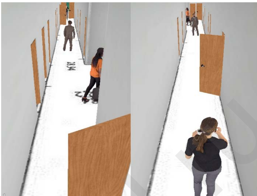
Моделирование изображения с видеокамер по концам коридора (IP Video System Design Tool)
