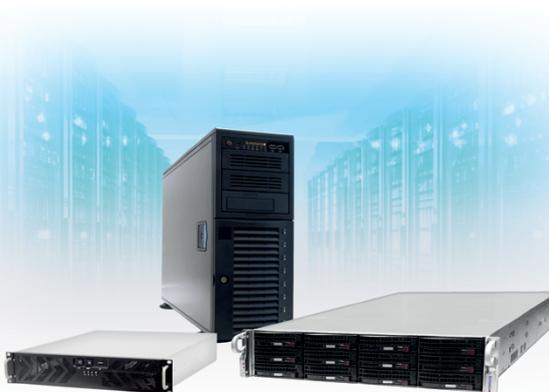
Сетевой видеосервер для систем IP-видеонаблюдения. Предназначен для записи изображения, полученного с IP-видеокамер, воспроизведения из архива и трансляции видеоданных на удалённые рабочие места. Видеосервер состоит из аппаратной платформы и программного обеспечения
