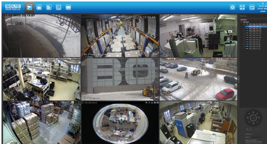
«Орион Видео Лайт» позволяет искать и настраивать камеры и видеорегистраторы «Болид», просматривать «живое» видео, делать скриншоты с выбранных камер и производить запись в архив. Также программа может управлять камерами, оснащенными PTZ или моторизованным объективом. «Орион Видео Лайт» позволяет использовать видеоаналитику камер «Болид» и работать с камерами, имеющими fisheye-объектив. Программа имеет удобный пользовательский интерфейс, позволяет
