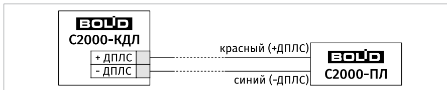
Рисунок 16. Типовая схема включения извещателя с кабелем №2 в ДПЛС КДЛ
