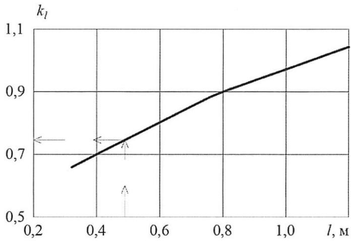
*a* – для положительных изгибающих моментов; *b* – для отрицательных изгибающих моментов; *в* – график для определения поправочного коэффициента  $k_l$  к переходному коэффициенту  $k$
