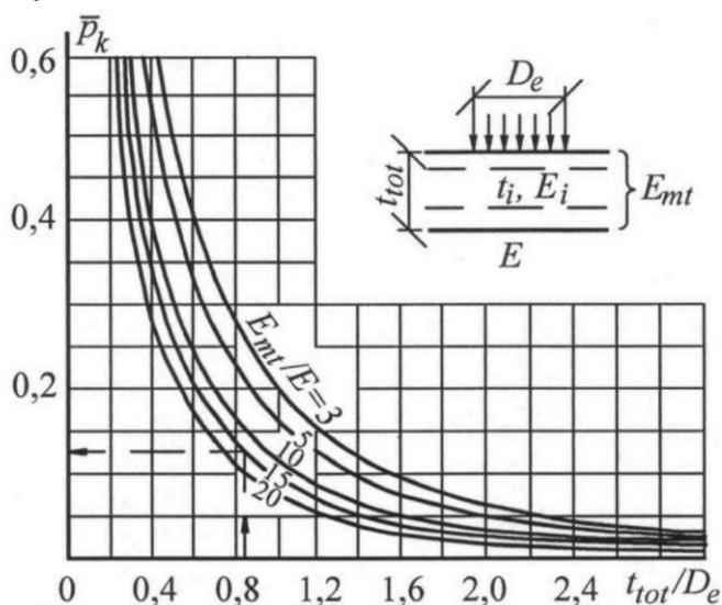
**Рисунок Ж.1 – Номограмма для определения удельных контактных давлений  $\bar{p}_k$  на поверхности грунтового основания нежестких покрытий**
