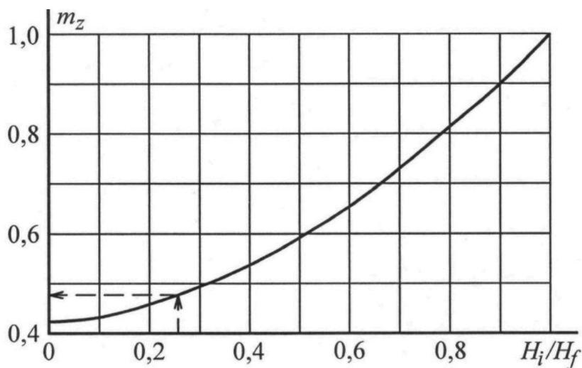
**Рисунок Е.2 – График для определения коэффициента  $m_z$**
