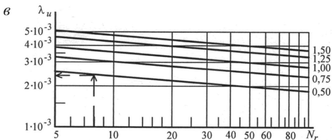
*а* – суглинки, глины, супеси (включая грунты с примесью гравия); *б* – песчаные пылеватые грунты; *в* – песчаные крупные, средней крупности и мелкие, галечниковые. Значения на линиях графика обозначают внутреннее давление воздуха в пневматиках колес воздушного судна  $P_a$ , МПа
