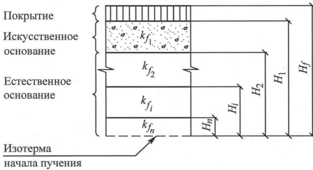
**Рисунок Е.1 – Расчетная схема слоистого основания**
