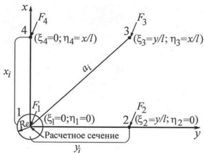
**Рисунок 7.2 – Расчетная схема параметров нагружения опор ВС**
