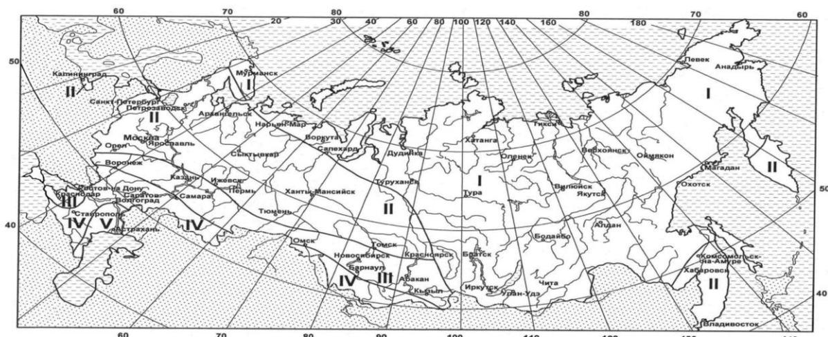
I – тундра, лесотундра и северо-восточная часть лесной зоны с распространением многолетнемерзлых грунтов; II – леса с избыточным увлажнением грунтов; III – лесостепная со значительным увлажнением грунтов в отдельные годы, IV – степная с недостаточным увлажнением грунтов; V – пустынная и пустынно-степная с засушливым климатом и распространением засоленных грунтов.
