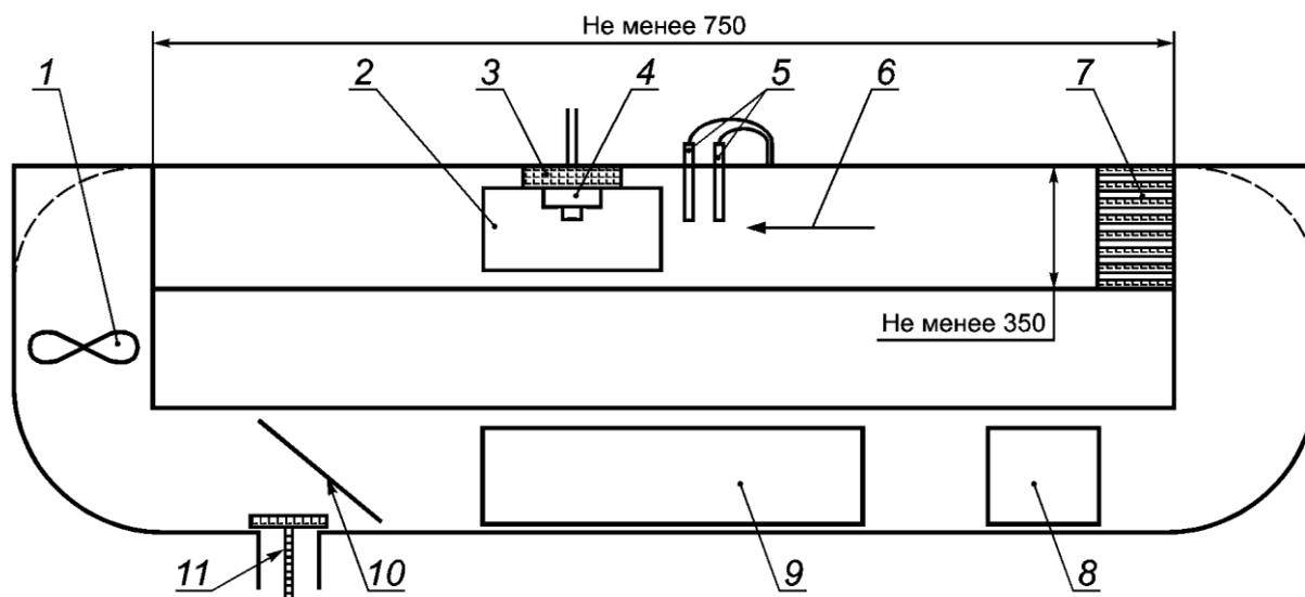
1 - вентилятор с двигателем; 2 - крышка отсека для установки испытуемого ИППТ со стеклянным смотровым окном; 3 - площадка с поворотным устройством для установки испытываемого ИППТ; 4 - испытуемый ИППТ; 5 - измерители температуры и скорости потока воздуха; 6 - направление потока воздуха; 7 - линейаризатор; 8 - крышка для установки холодильного агрегата для испытаний при пониженных температурах; 9 - отсек нагревателя; 10 - регулятор скорости потока воздуха; 11 - вентиляционное отверстие
