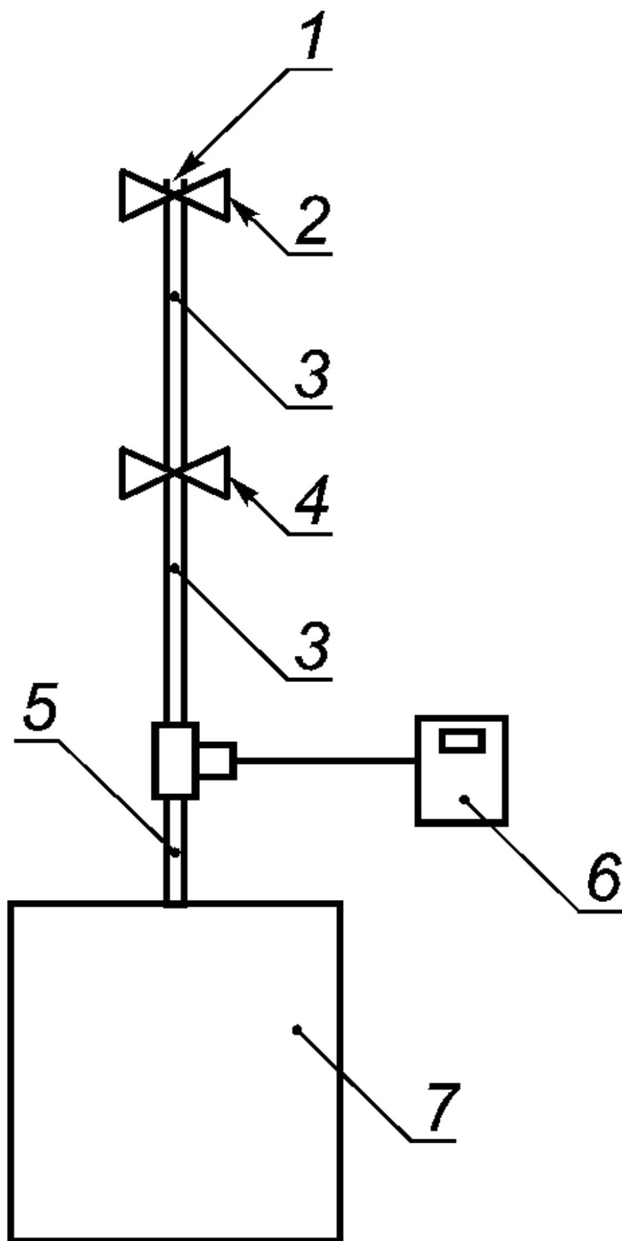
1 - открытый конец тестового трубопровода; 2 - вторичный регулируемый клапан; 3 - тестовый трубопровод длиной (1-2) м без воздухозаборных отверстий и дополнительных компонентов; 4 - первичный регулируемый клапан; 5 - отрезок тестового трубопровода длиной не менее 30 см; 6 - анемометр; 7 - испытуемый ИПДА
