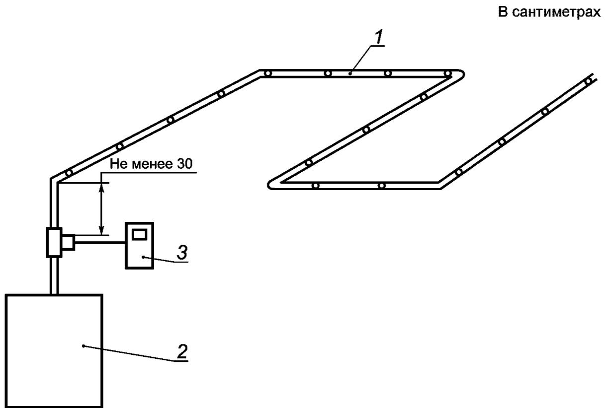
1 - воздушный трубопровод (с установленными в худшем сочетании для проведения огневых испытаний дополнительными компонентами); 2 - испытуемый ИПДА; 3 - анемометр
