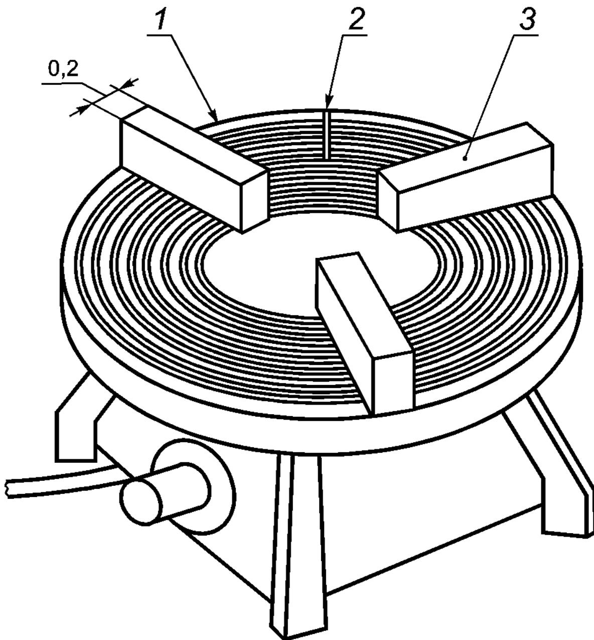
1 - плита; 2 - термопара; 3 - деревянные бруски
