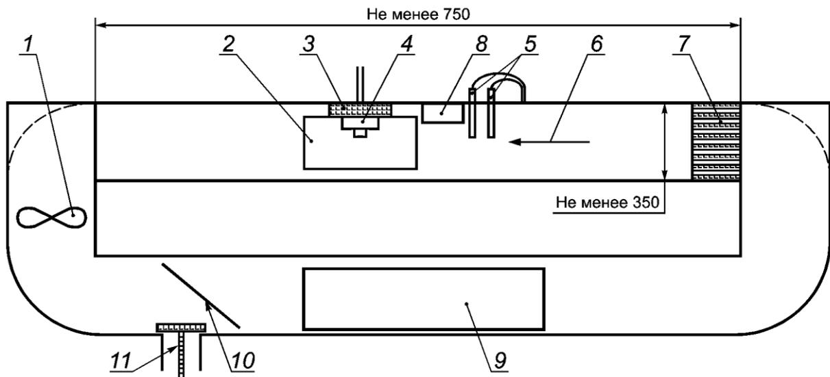
1 - вентилятор с двигателем; 2 - крышка отсека для установки испытываемого ИПДИ со стеклянным смотровым окном; 3 - площадка с поворотным устройством для установки испытываемого ИПДИ; 4 - испытуемый ИПДИ; 5 - измерители температуры и скорости потока воздуха; 6 - направление потока воздуха; 7 - линейризатор; 8 - контрольная ионизационная камера; 9 - отсек нагревателя; 10 - регулятор скорости потока воздуха; 11 - вентиляционное отверстие
