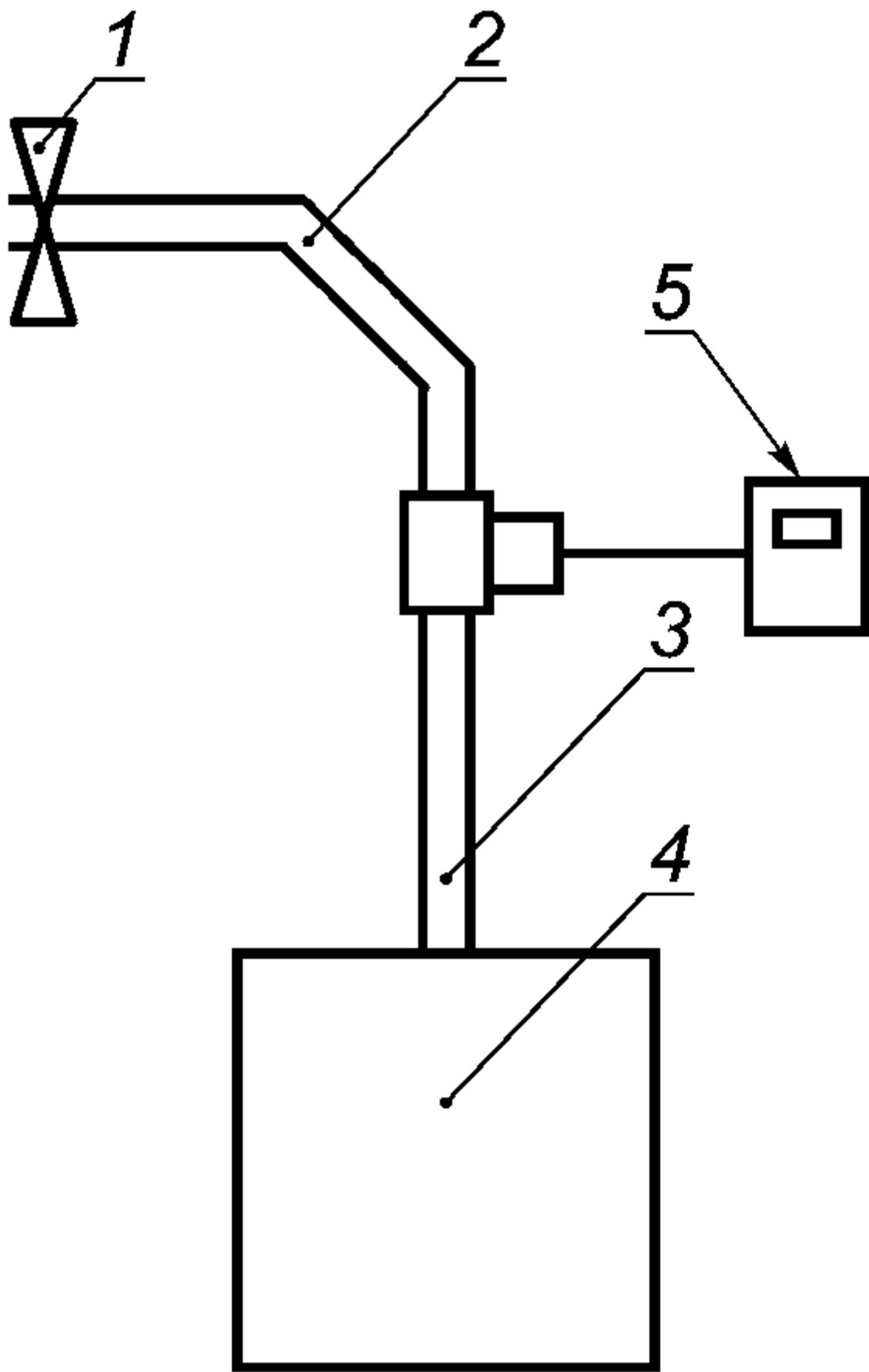
1 - регулируемый клапан; 2 - фрагмент тестового трубопровода; 3 - отрезок тестового трубопровода длиной не менее 30 см; 4 - испытываемый ИПДА; 5 - анемометр
