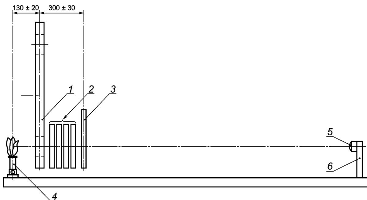
1 - модулятор; 2 - нейтральные аттенюаторы; 3 - затвор; 4 - метановая горелка; 5 - извещатель; 6 - стойка извещателя
