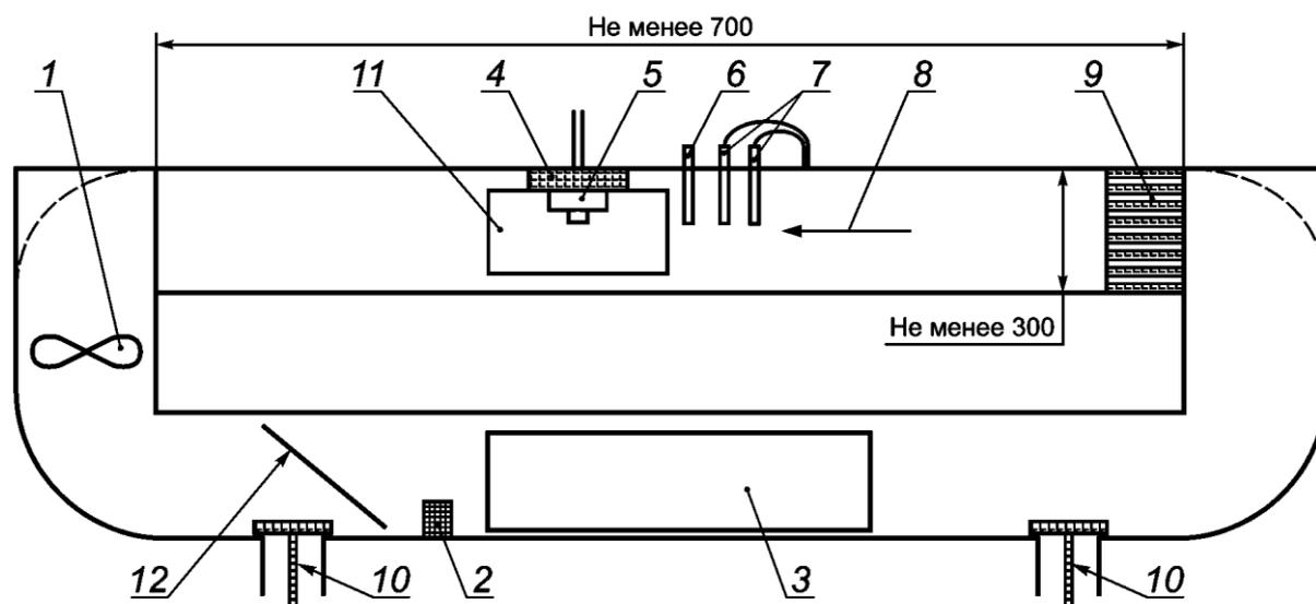
1 - вентилятор с двигателем; 2 - вводной патрубок газа; 3 - отсек нагревателя; 4 - площадка с поворотным устройством для установки испытуемого ИПГ; 5 - испытуемый ИПГ; 6 - газоанализатор; 7 - измерители температуры и скорости потока воздуха; 8 - направление потока воздуха; 9 - линеаризатор; 10 - приточно-вытяжная вентиляция; 11 - крышка отсека для установки испытуемого ИПГ со стеклянным смотровым окном; 12 - регулятор скорости потока воздуха
