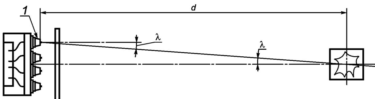
1 - испытываемые ИПП; d - расстояние между ИПП и тестовым очагом; λ - максимальный угол отклонения оптической оси ИПП от направления на тестовый очаг, равный  $0^\circ \pm 5^\circ$
