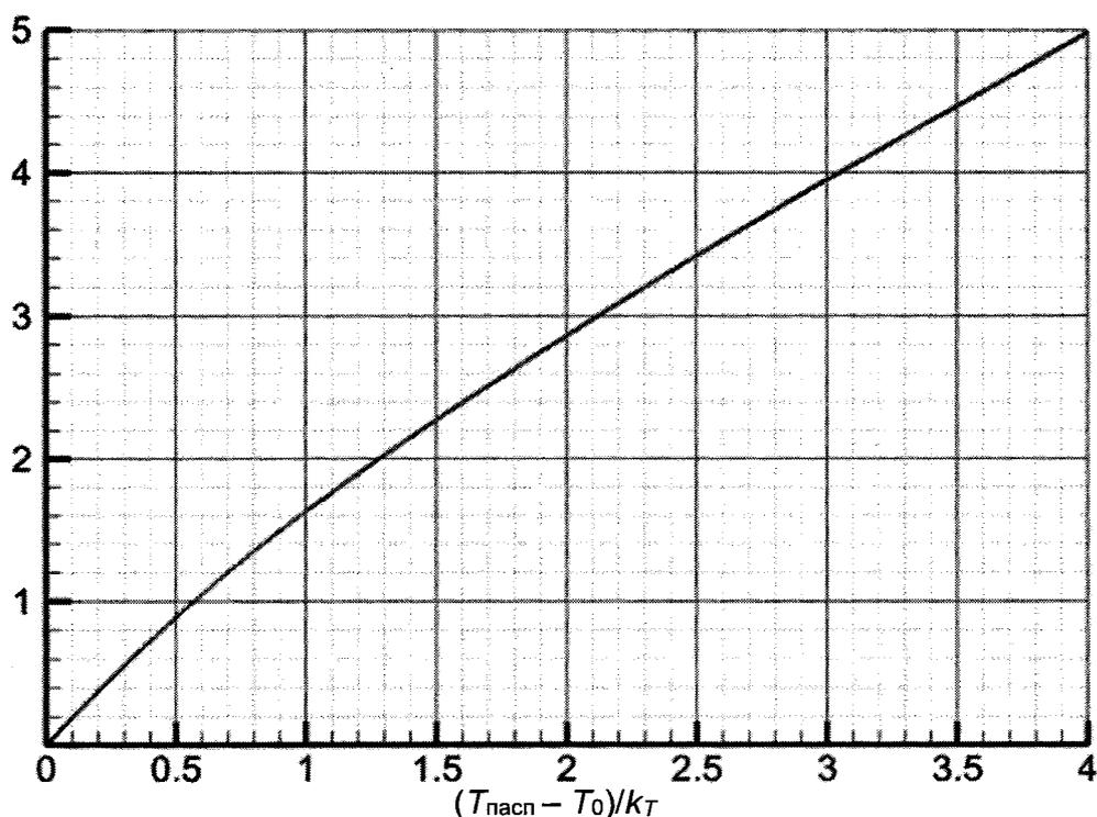
Рисунок В.2 – График для интерполяционного определения времени активации спринклерного оросителя при термическом разрушении колбы
