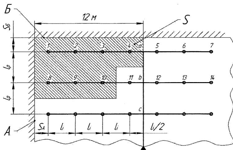
1-14 – оросители;  $l_i$  – расстояние между оросителями в рядке;  $l_p$  – расстояние между рядками;  $S_A$  – расстояние от крайних оросителей до стены А ( $S_A \leq l_i/2$ );  $S_B$  – расстояние от наиболее удаленного рядка до стены Б ( $S_B = l_p/2$ );  $S_d$  – защищаемая орошением диктующая зона (не менее минимальной площади орошения)
