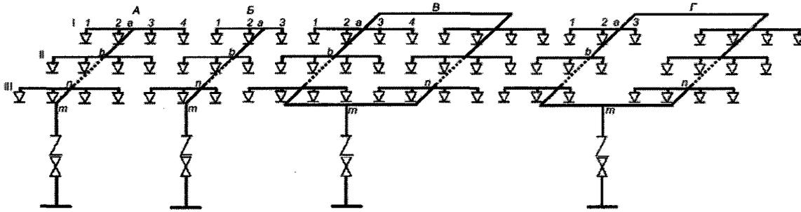
*A* – тупиковая секция с симметричным расположением оросителей; *Б* – тупиковая секция с несимметричным расположением оросителей; *В* – секция с симметричным кольцевым питающим трубопроводом; *Г* – секция с несимметричным кольцевым питающим трубопроводом; *I, II, III* – рядки распределительного трубопровода; *a, b... n, m* – узловые расчетные точки; *1, 2, 3, 4* – оросители
