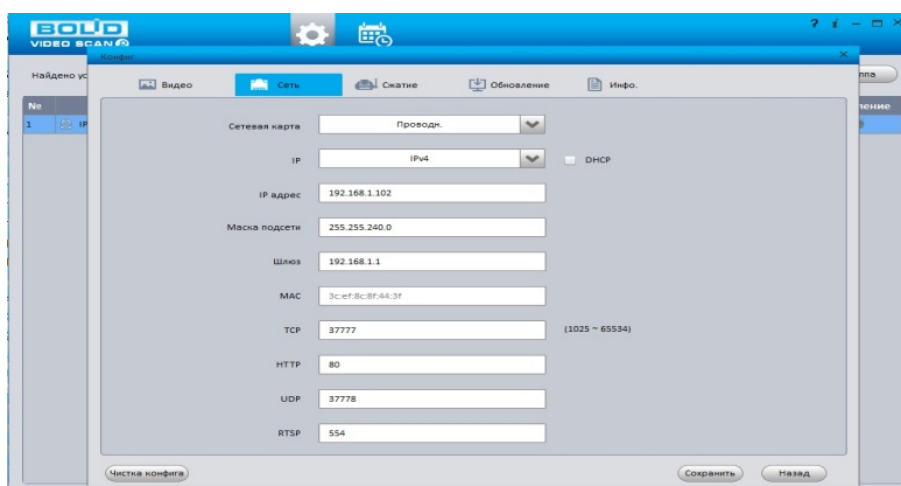
Рисунок 9.2 – Изменение IP-адреса с помощью утилиты «BOLID VideoScan»
