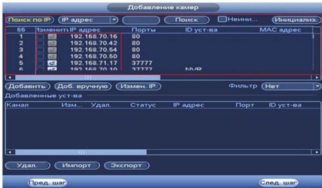
Рисунок 6.10 Настройка добавления камер по поиску в сети.
