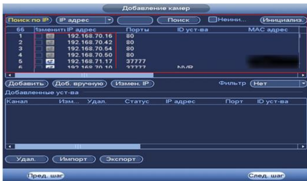
Рисунок 6.10 Настройка добавления камер по поиску в сети.
