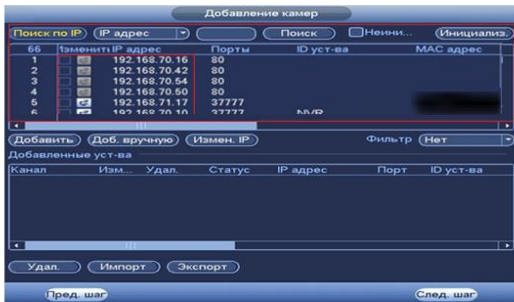
Рисунок 6.10 Настройка добавления камер по поиску в сети.
