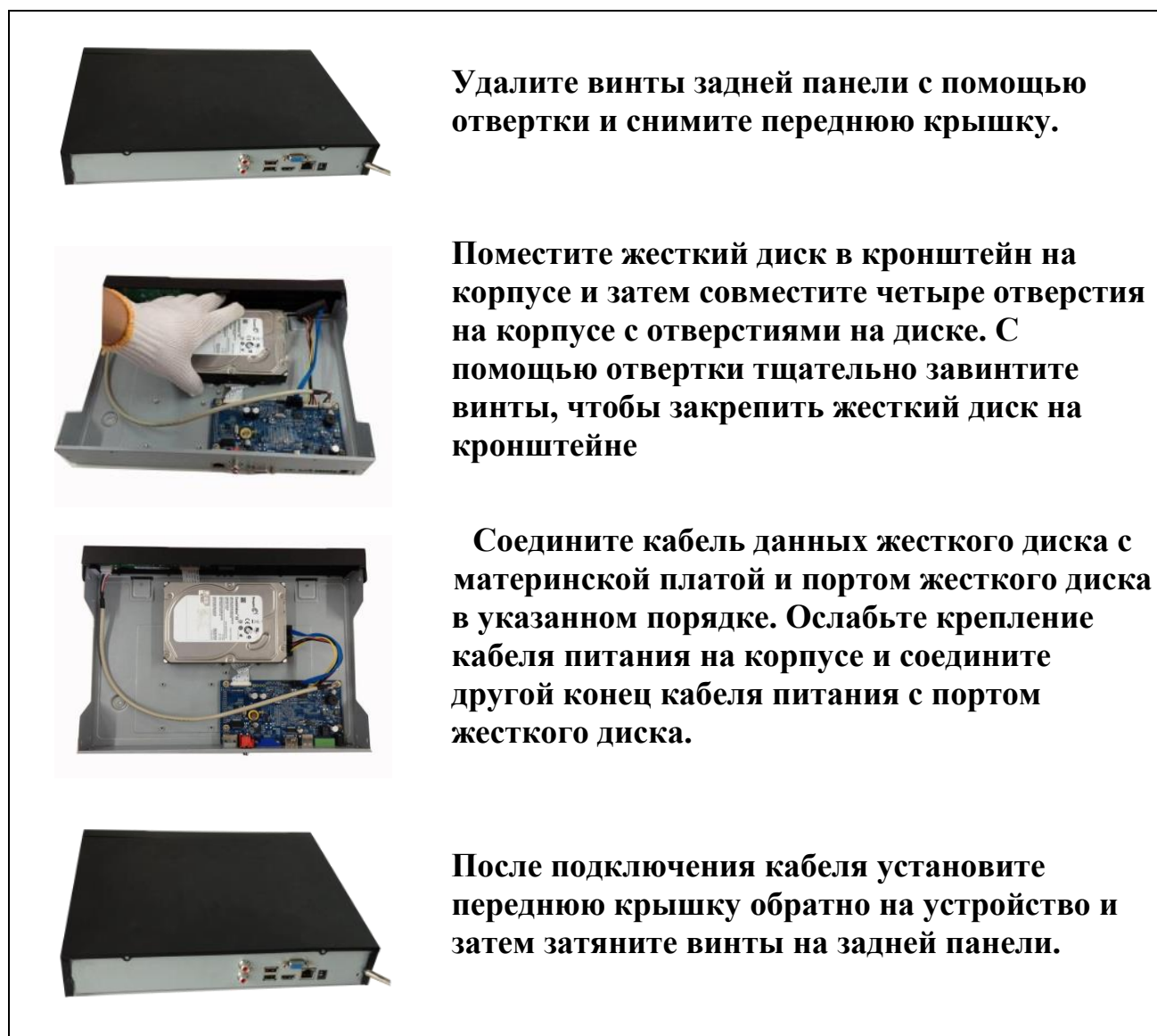
Рисунок 5.1 Установка жесткого диска
