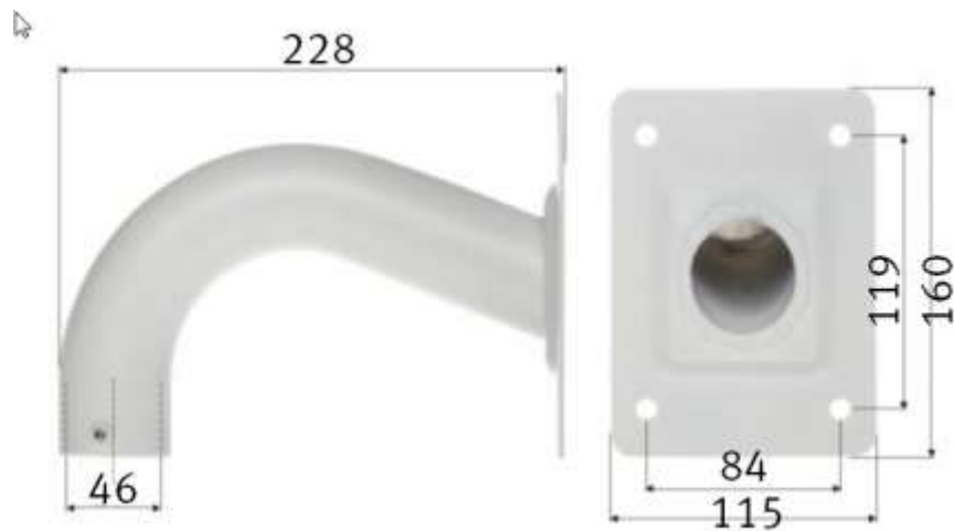
Рисунок 1.2 – Габаритные размеры настенного кронштейна
