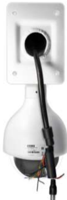
Рисунок 1.3 – Кабель видеокамеры внутри настенного кронштейна
