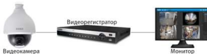
Рисунок 2.2 – Схема подключения видеокамеры
