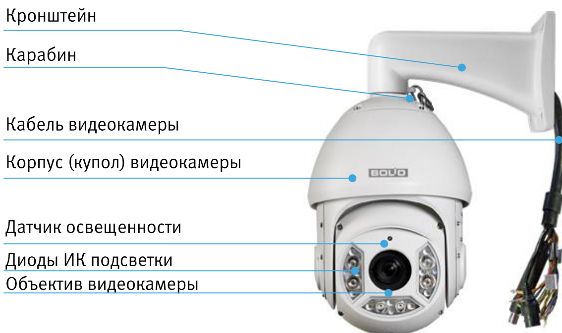
Рисунок 4.1 - Внешний вид и основные элементы видеокамеры
