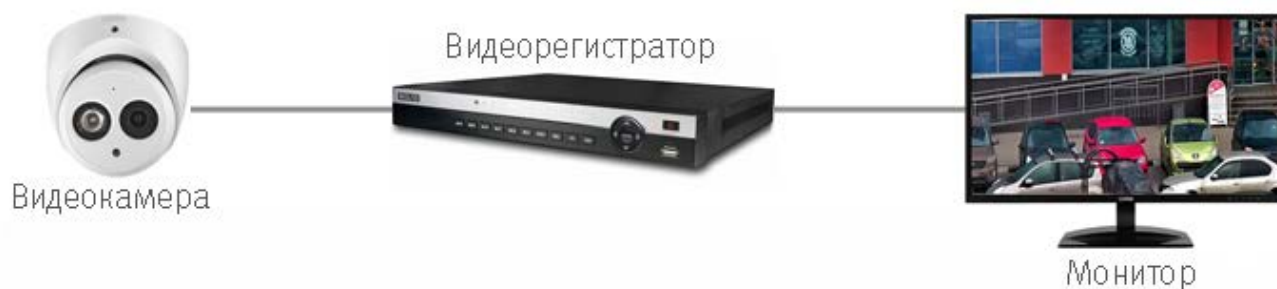
Рисунок 6.2 — Схема подключения видеокамеры
