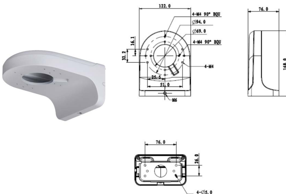
Рисунок 5.7 — Внешний вид и габаритные размеры кронштейна BR-105
