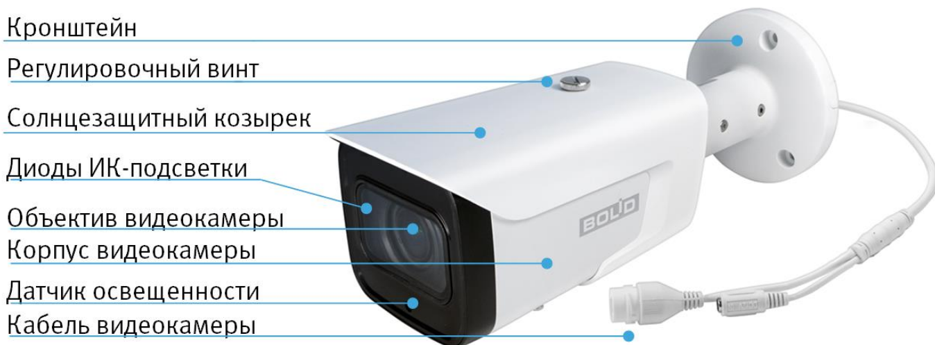
Рисунок 4.1 - Внешний вид и основные элементы видеокамеры
