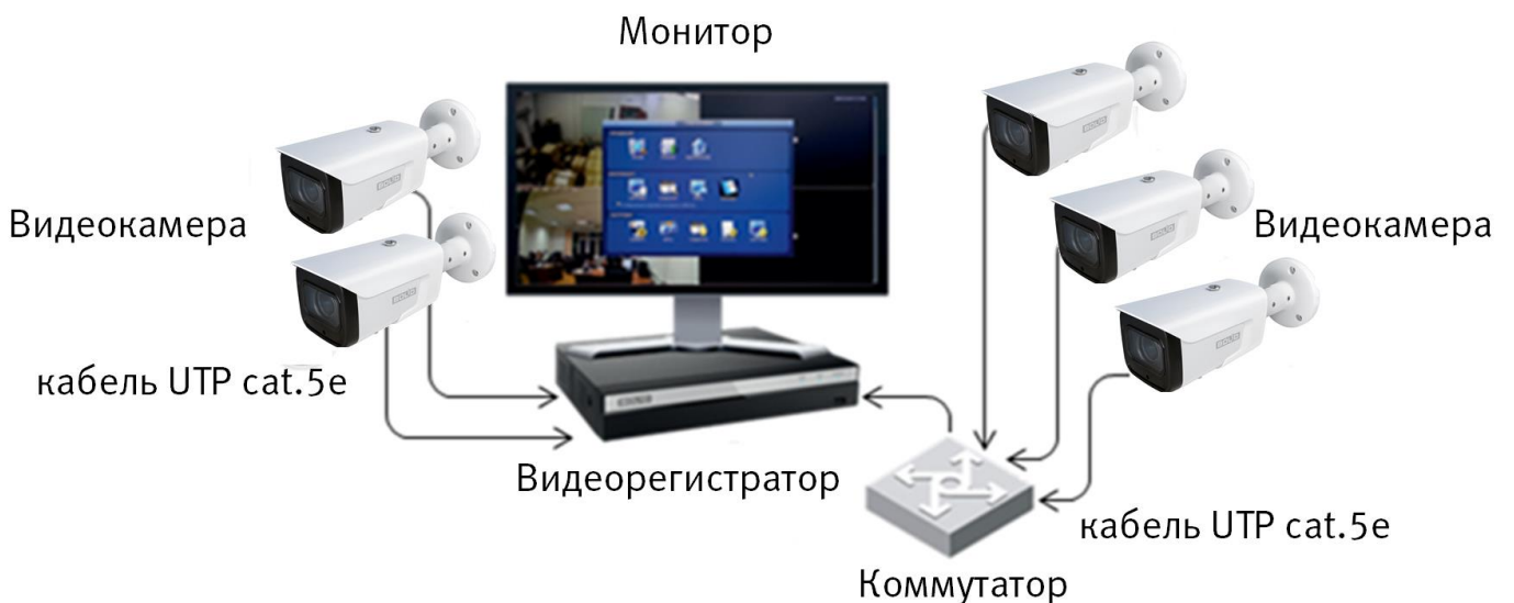
Рисунок 6.4 – Схема подключения видеокамеры к видеорегистратору
