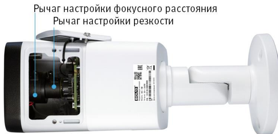
Рисунок 5.14 – Настройка фокусного расстояния и резкости
