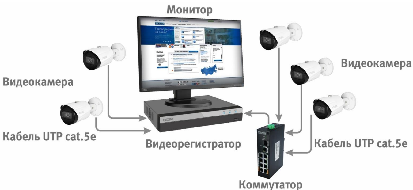
Рисунок 6.4 – Схема подключения видеокамеры к видеорегистратору
