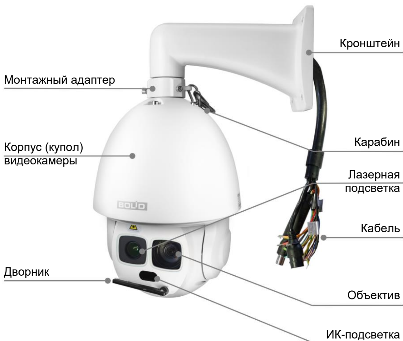
Рисунок 4.1 – Внешний вид и основные элементы видеокамеры
